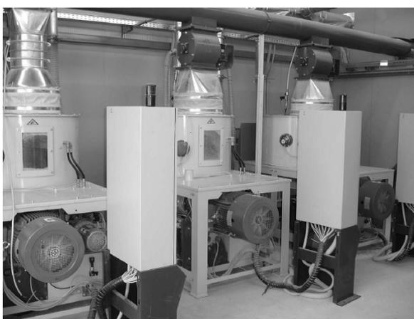
Figura 32 – Linha de produção com 3 peletizadoras (Fonte: <http://www.arsalambiente.pt/docs/Sistema%20de%20Pellets.pdf>)
