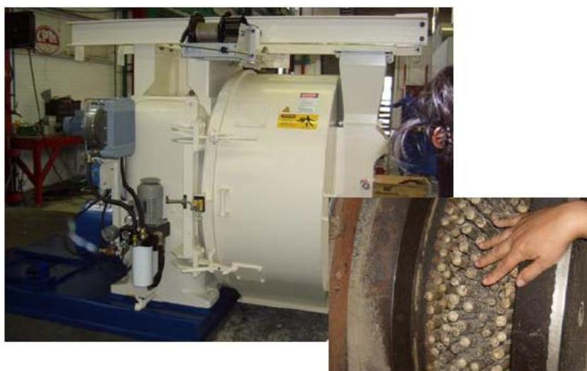
Figura 35 - Máquina peletizadora de matriz cilíndrica vertical (anel) (Fonte: Loução, 2008).
