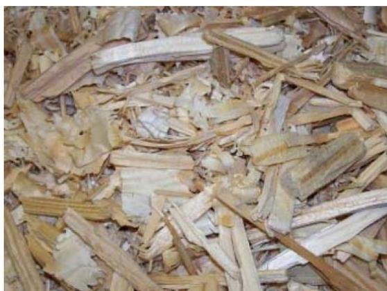
Figura 23 - Estilha resultante de uma trituração com martelos (Fonte: www.bmandm.com).
