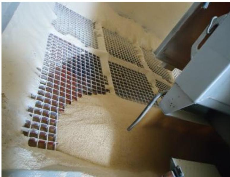
Figura 2 - Descarga de matérias-primas no tegão
