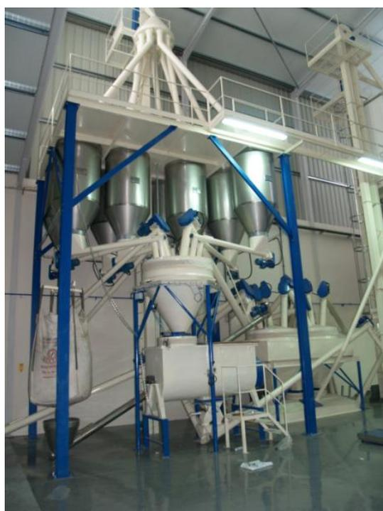
Figura 6 - Zona de pré-mistura e pesagem.
