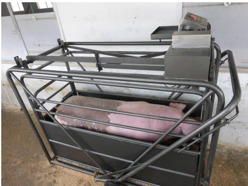
Figura 22 - Balana de pesagem de animais com capacidade at 300kg (Foto prpria, 2014).
