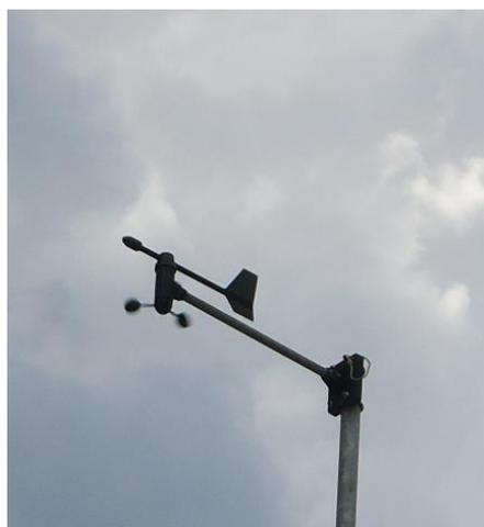
Figura 16 - Sensor de direcção do vento (Foto própria, 2012).
