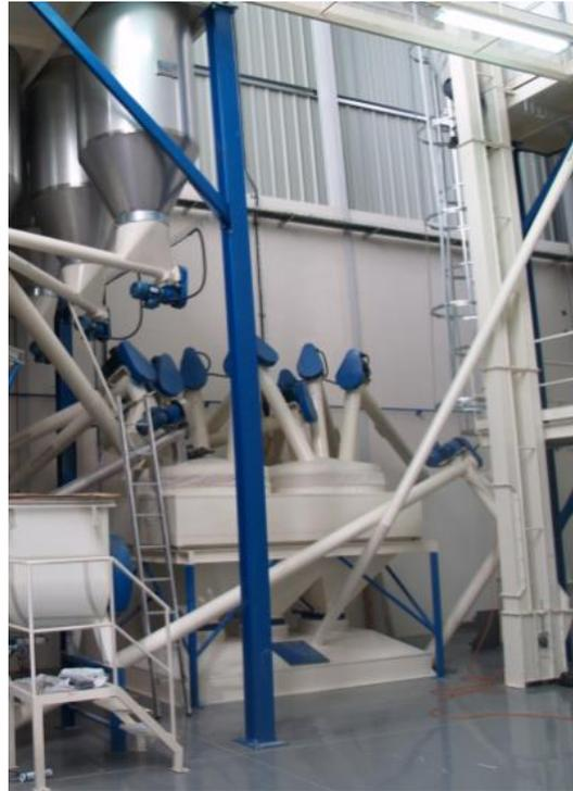
Figura 4 - Pesagem dos ingredientes em balança de 2 toneladas.
