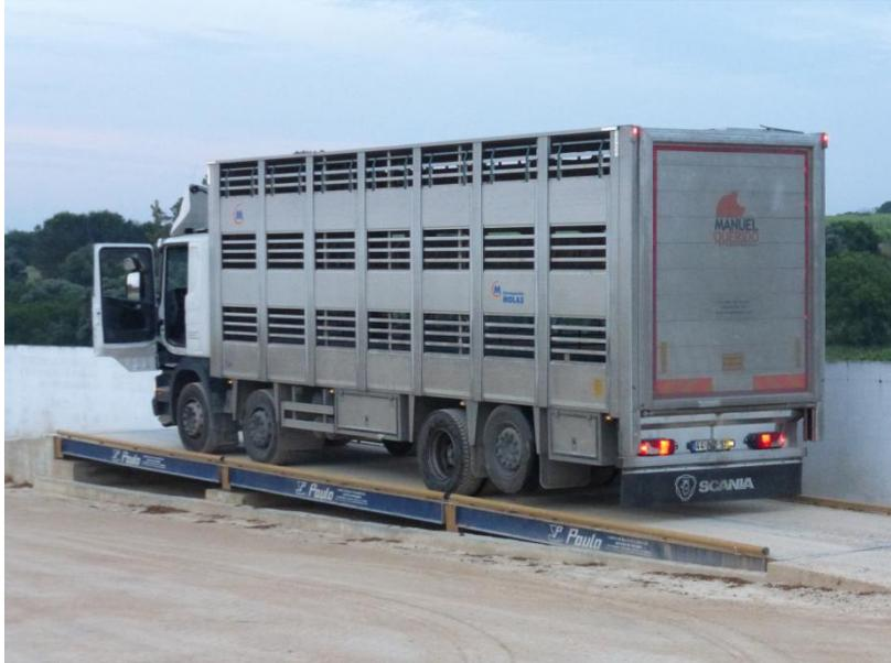
Figura 21 - Bscula da explorao para pesagem de veculos (Foto prpria, 2014).
