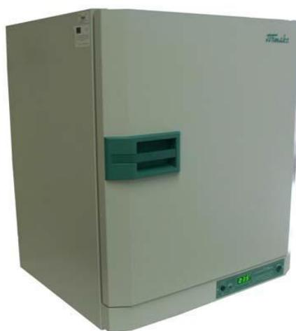
Figura 4.4 Estufa utilizada nos ensaios de difusão.
