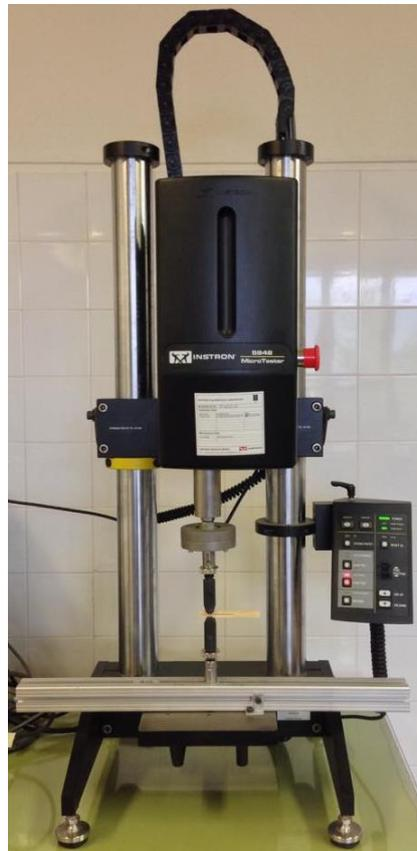
Figura 4.7 Máquina INSTRON com célula de carga de 2 kN.
