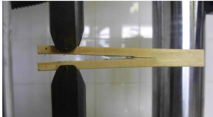
Figura 4.9 Propagação de fenda do provete para  $a_{03}$ .
