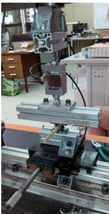
Figura 4.6 Ligação do provete à máquina de ensaio com célula de carga de 5 kN.
