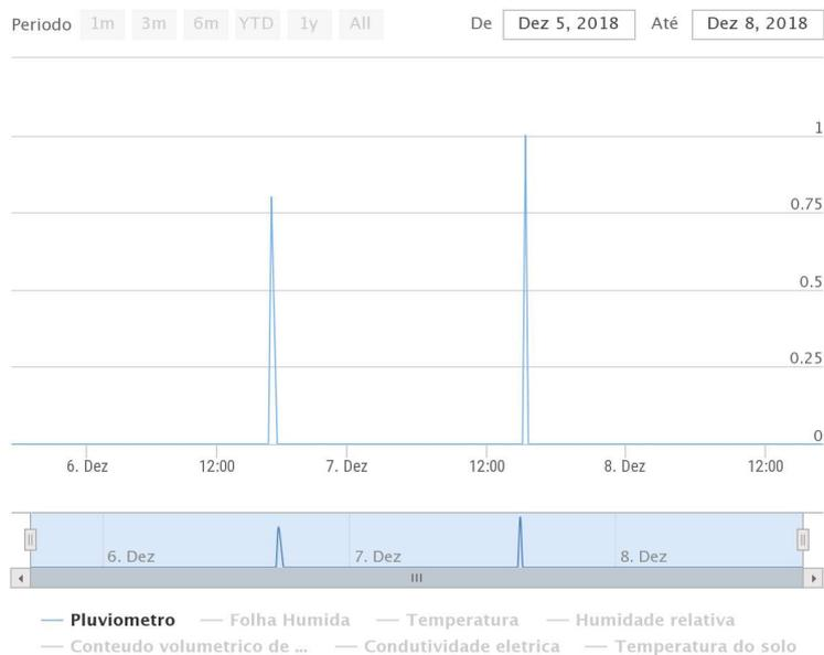
Figura 5.9 – Gráfico ilustrativo aos resultados dos dados do sensor pluviómetro na plataforma mySense.
