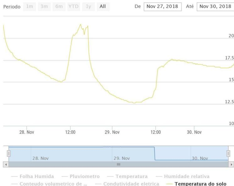
Figura 5.10 – Gráfico ilustrativo aos resultados dos dados do sensor 5TE - temperatura do solo na plataforma mySense.
