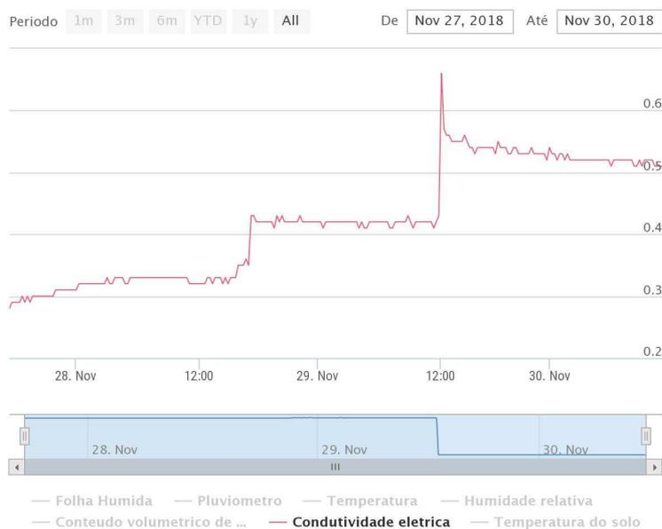
Figura 5.11 – Gráfico ilustrativo aos resultados dos dados do sensor 5TE - condutividade elétrica do solo na plataforma mySense.
