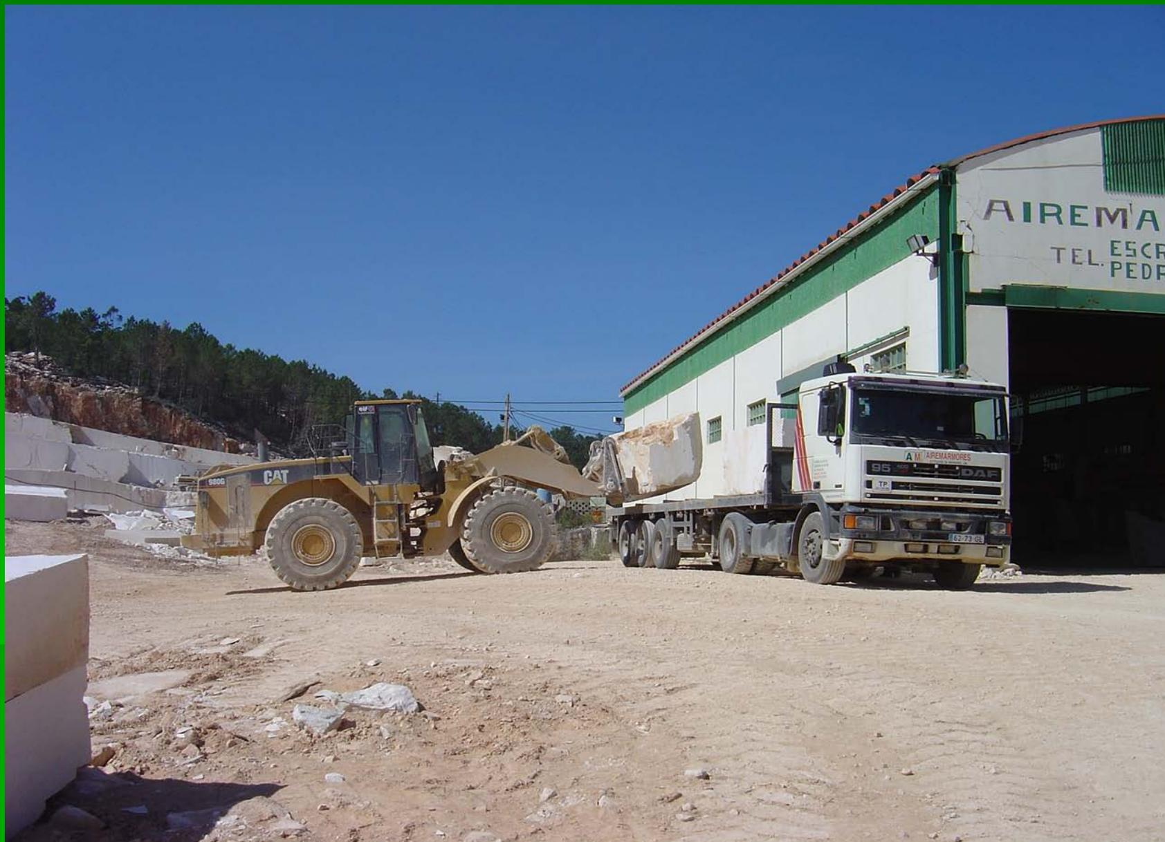
**Acção de carregamento de blocos comerciais em camião que procede à sua expedição, para as unidades de serragem, corte e polimento.**
