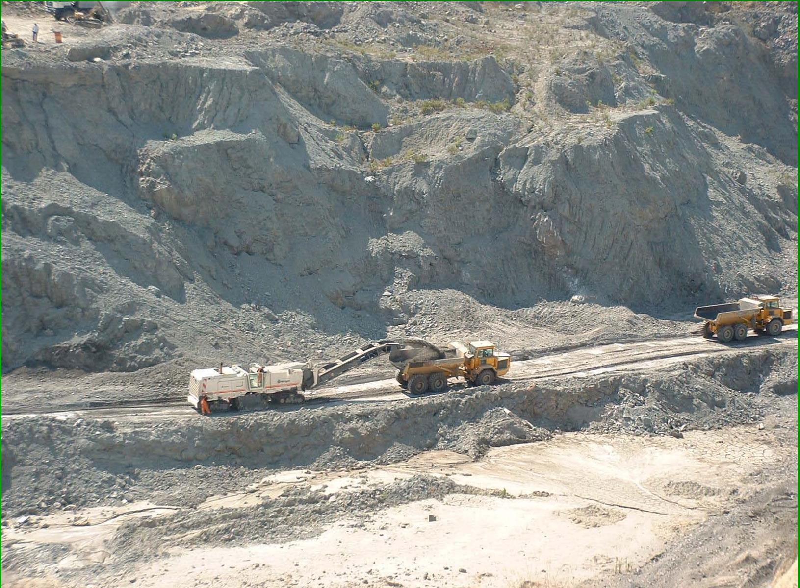
**Operação de desmonte por roçadora de bancada.**
