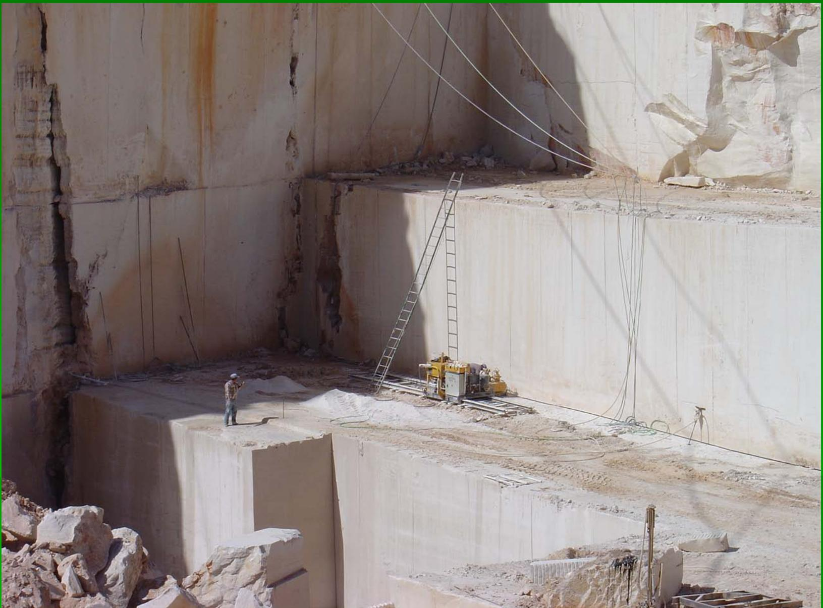
**Limpeza da zona do bloco primário para a realização de um furo vertical. Podem observar-se a marca de dimensionamento, o martelo pneumático e as barrenas a utilizar na execução do furo.**
