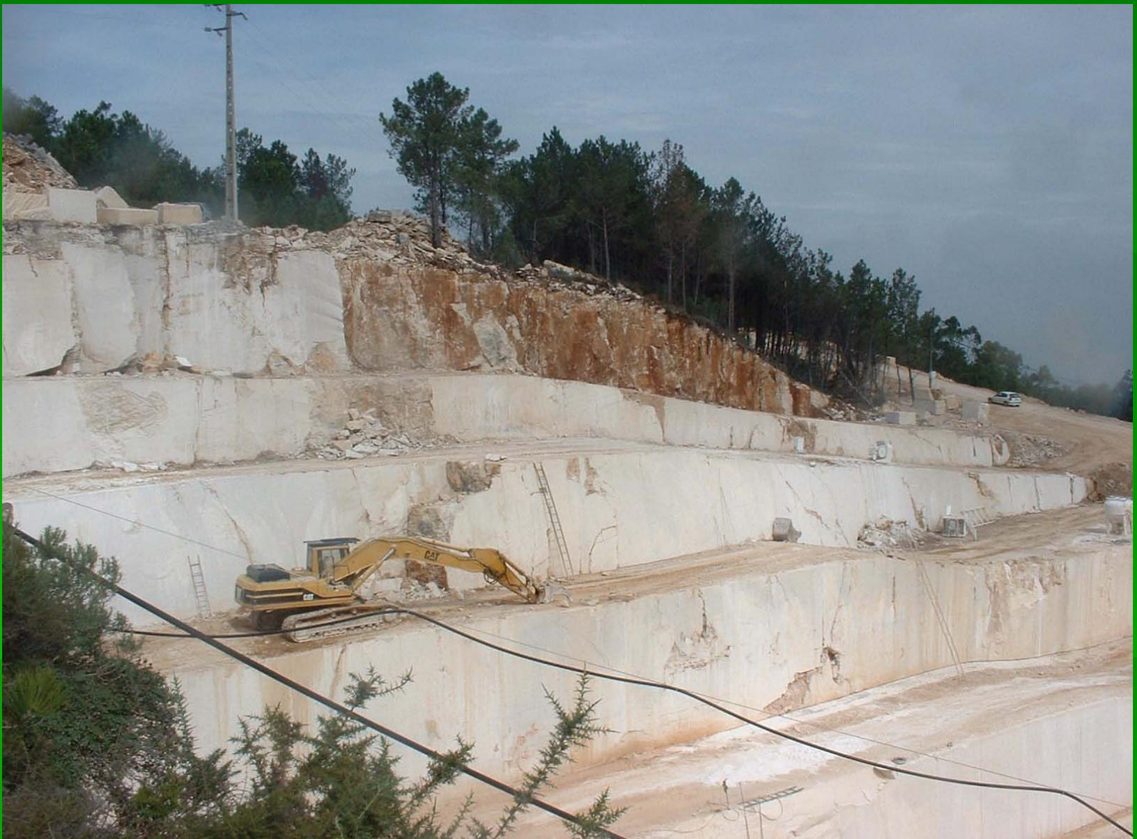
**Preparação da bancada para a realização dos furos verticais. A escavadora giratória abre um sulco a todo o comprimento da bancada, distanciado da frente o equivalente à largura do bloco primário.**
