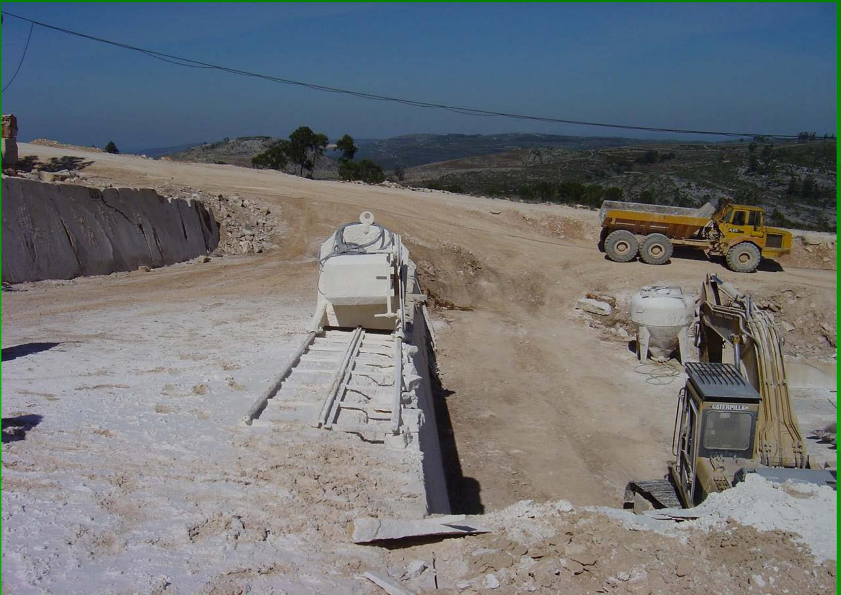
**Operação de corte lateral por acção de máquina de fio diamantado, com vista á individualização do bloco primário.**
