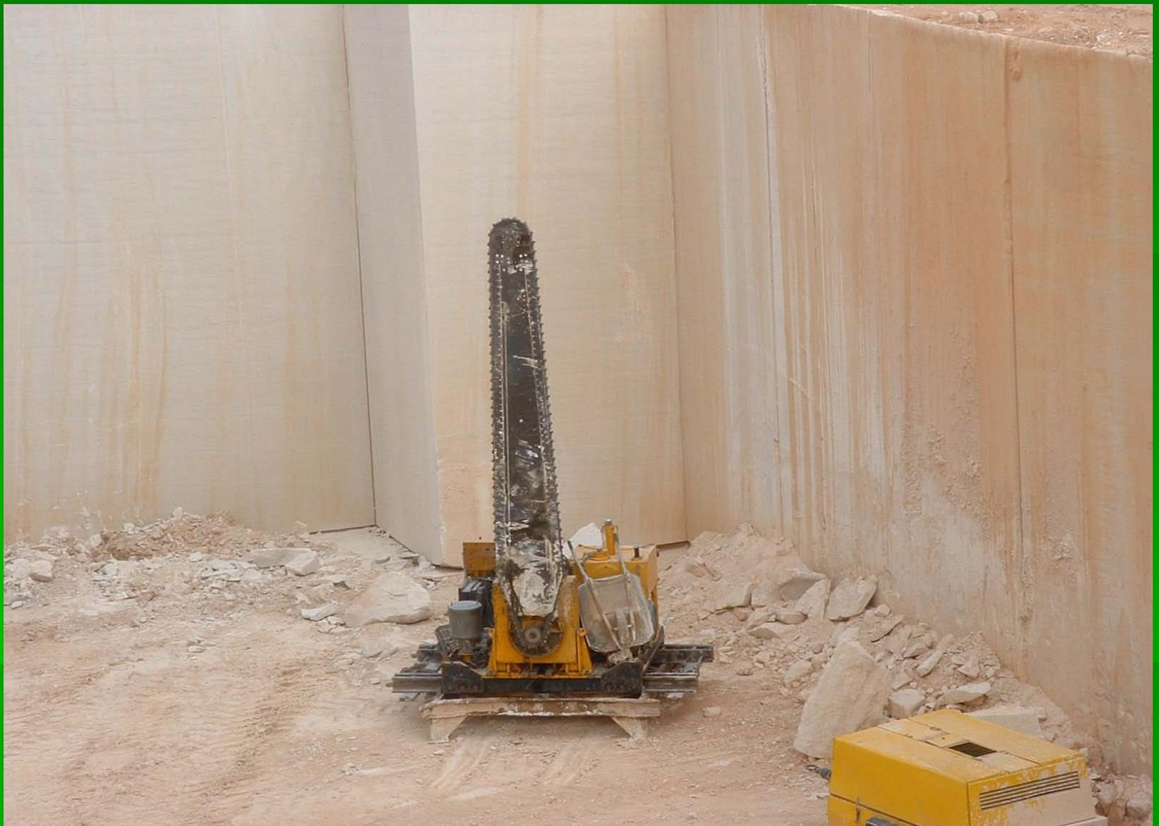
**Vista da roçadora de corrente que efectua corte de levante (corte horizontal de fundo). Em segundo plano, identifica-se o corte de levante já efectuado no maciço calcário.**
