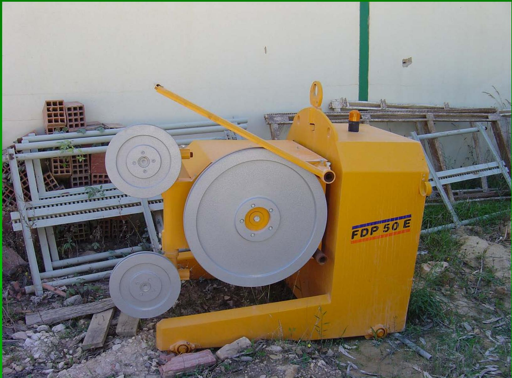
**Máquina de corte através de fio diamantado.**
