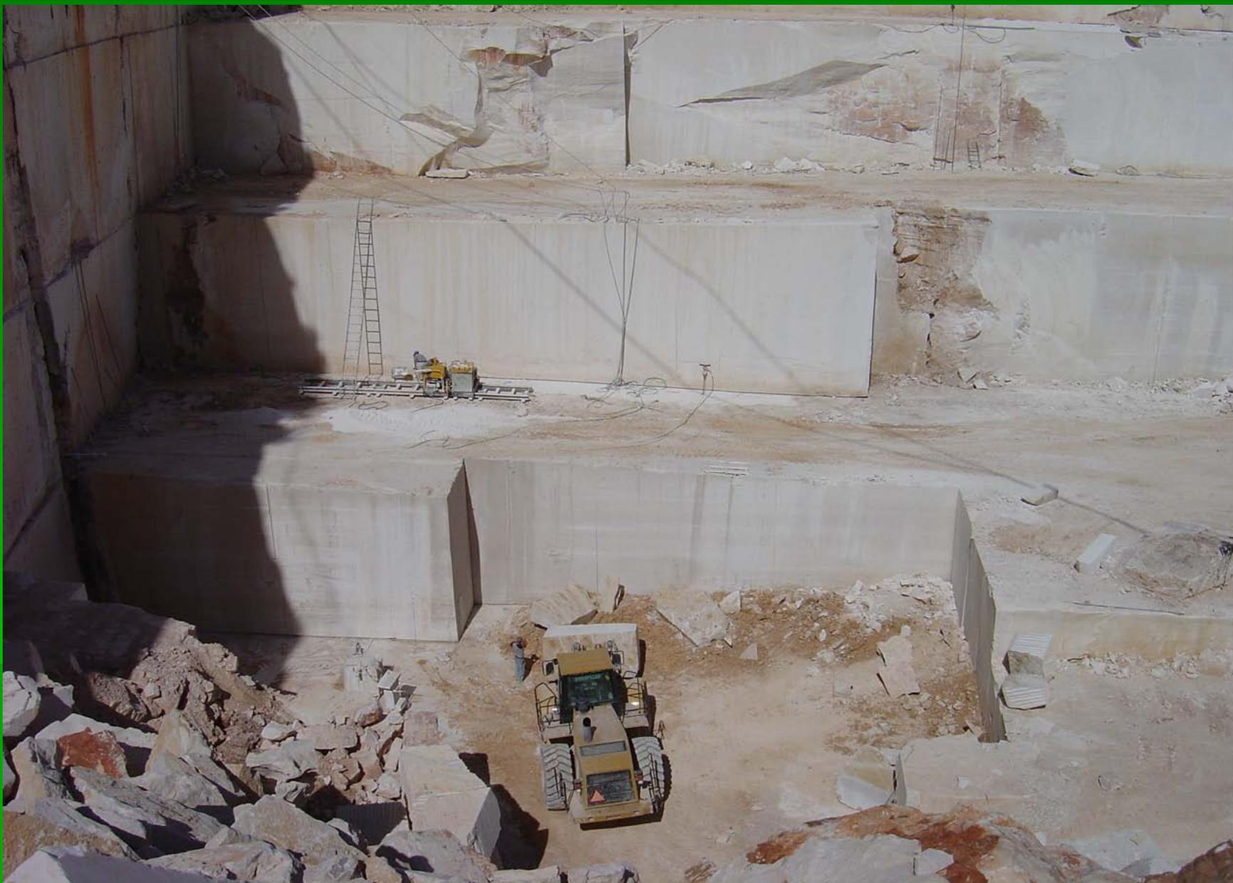
**Operação de carregamento, na frente de desmonte, de bloco transportável, por acção de pá carregadora.**
