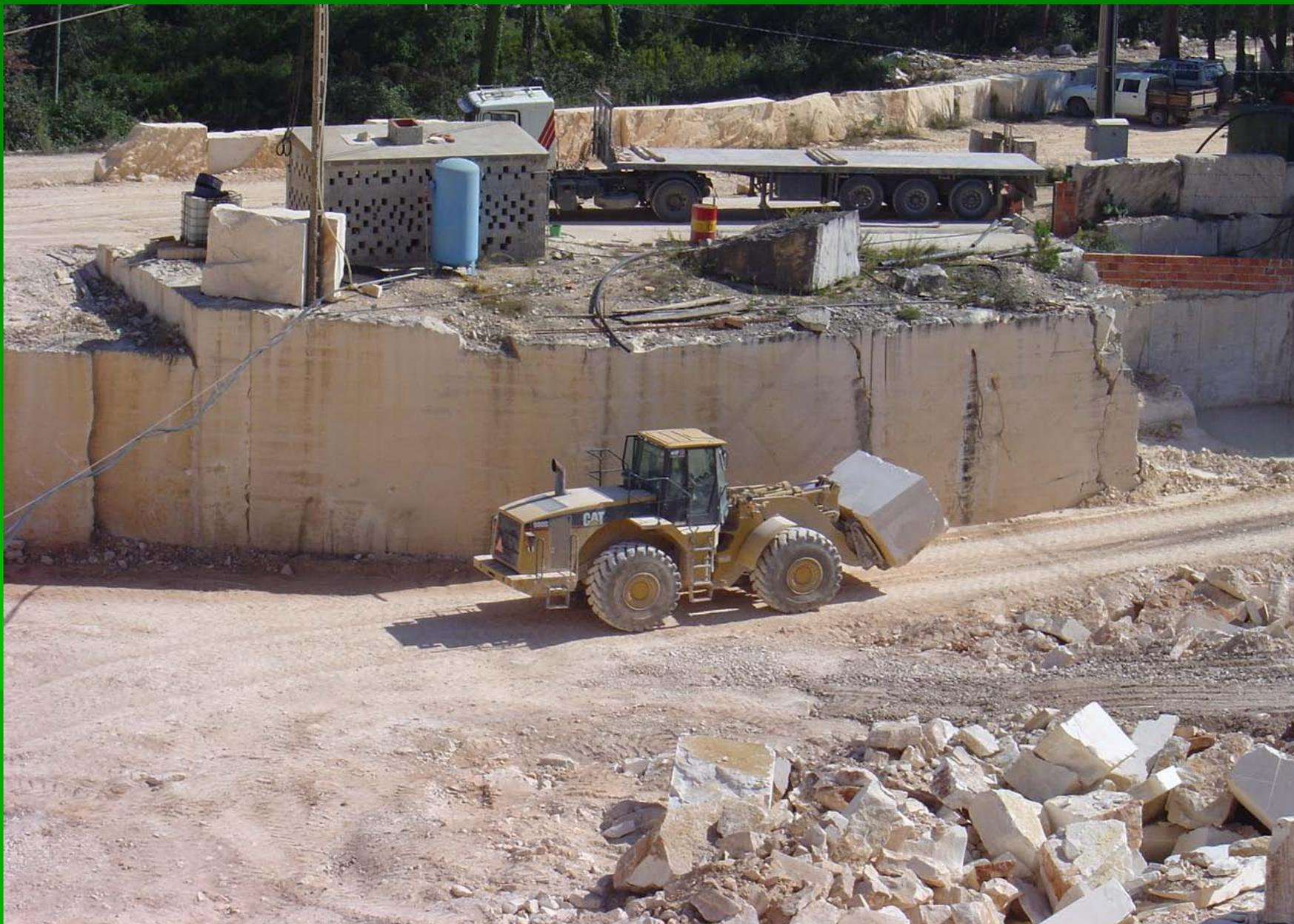
**Acção de transporte por pá carregadora de bloco com valorização comercial para o parque de blocos.**
