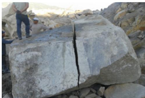
Exemplo de utilização do cordão detonante para realizar uma corte num bloco livre.
