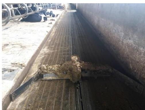
Figura 5.4 - Rodo de limpeza automática em corredor em cimento riscado
