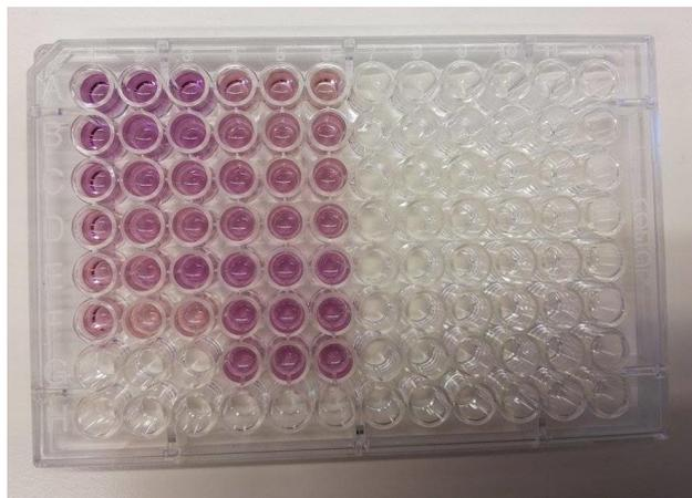
Figura 10: Microplaca com a curva-padrão do DPPH e amostras.
