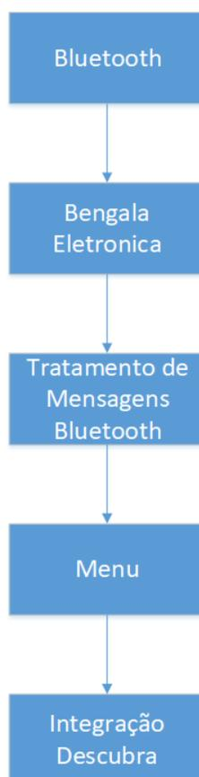
FIGURA 3 - FLUXOGRAMA DA INTERAÇÃO COM A BENGALA ELETRÓNICA.
