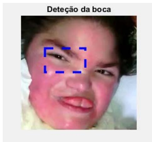
Figura 18 - Erro na detecção da boca.
