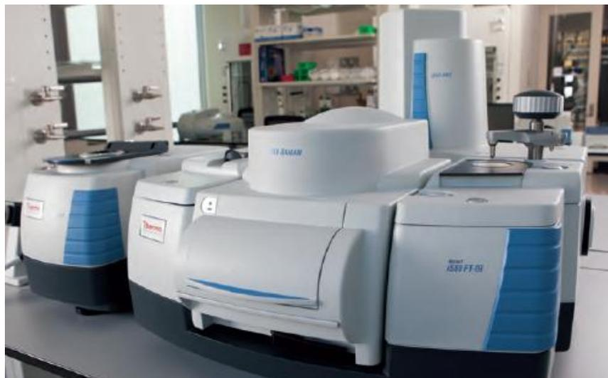
**Figura 6**-Espectrômetro FTIR Thermo Scientific Nicolet iS50 equipado com acessório ATR e DRIFT (Thermo Scientific, 2012).
