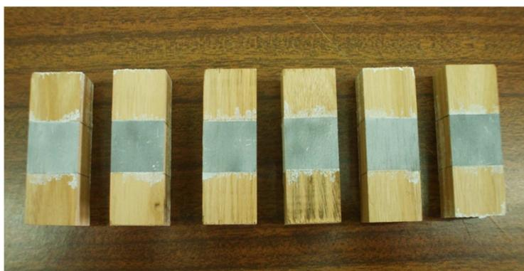
**Figura 127:** Provetes a serem usados nos ensaios compressão paralela às fibras: antes do ensaio.
