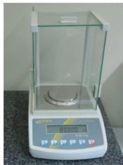
**Figura 131:** Balança Digital.
