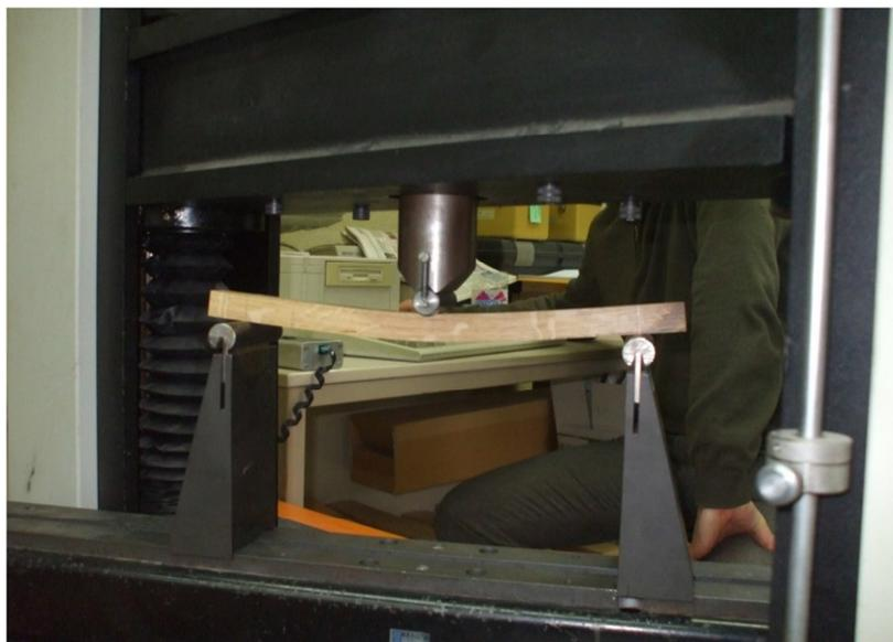
**Figura 125:** Decorrer de um ensaio de flexão estática.
