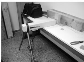
**Figura 116:** Equipamento do Resistograph, [FONTE: (LLADRÓ, et *alli*; 2006)].
