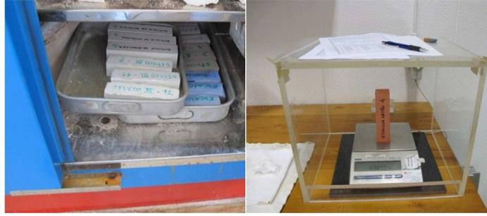
**Figura 86:** Estufa ventilada e balança [FONTE: Estudo do desempenho de estuques]
