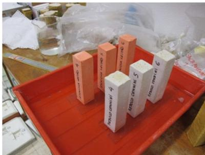
**Figura 87:** Ensaio de absorção de água por capilaridade [FONTE: Estudo do desempenho de estuques].
