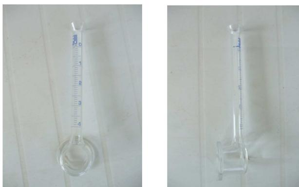
**Figura 56:** Tubo de Karsten para Paredes
