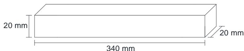
**Figura 124:** Dimensão dos provetes para os ensaios da flexão estática.
