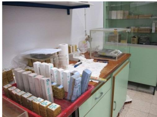
**Figura 85:** Ensaio de absorção de água [FONTE: Estudo do desempenho de estuques]
