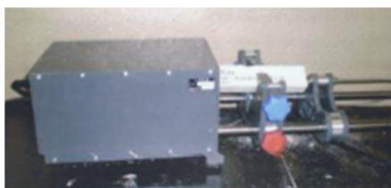
**Figura 90:** Equipamento para medição do Módulo de Elasticidade Dinâmica
