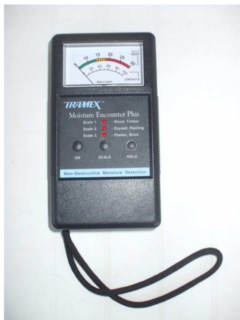
**Figura 57:** Aparelho portátil de medição de humidade
