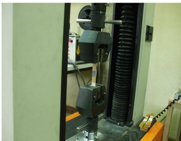
**Figura 123:** Provede do ensaio de tracção instalado na máquina INSTRON 1125.
