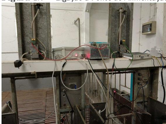
Figura 4.8 – Montagem Geral da Ligação à Fonte de Alimentação e ao Atuador
