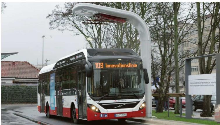
**Figura 2.22** – Autocarro elétrico em recarregamento através do sistema *Siemens Offboard* (Engineers Journal, 2017).
