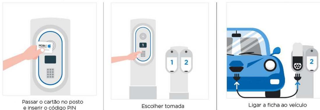
**Figura 2.13** – Esquema de carregamento de veículos elétricos (MOBIE, 2017)
