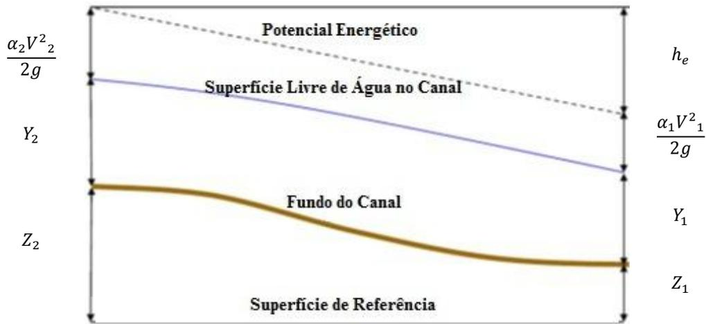
Figura 2.2. Termos da equação unidimensional da conservação de energia (Eq. 2.1) (USACE, 2010).
