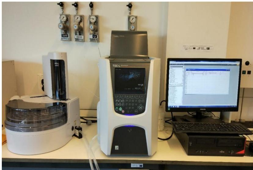
Figura 2.1 - Equipamento utilizado para determinação de COT.
