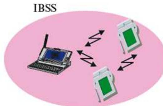
Figura 2.7 – Modo de *ad hoc* em tecnologia Wi-Fi (Labioud et al., 2007).
