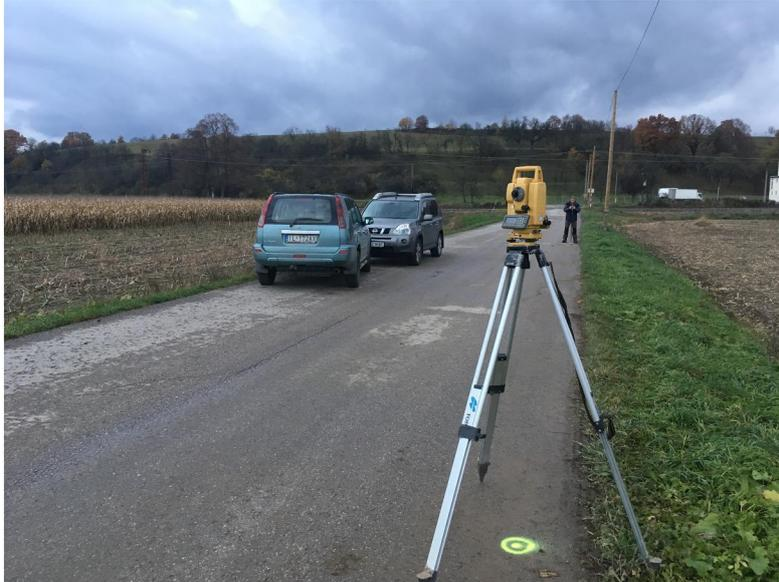
**Figura 5.9** – Medições de distâncias recorrendo à estação total Topcon GPT-3005N.
