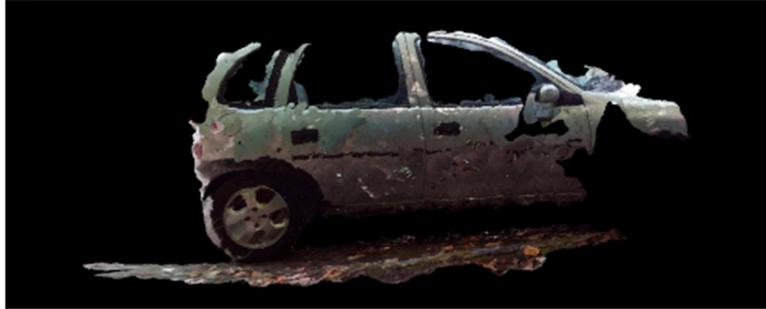
**Figura 5.20** – Reconstrução 3D da parte do veículo obstruída pela vegetação, recorrendo a imagens obtidas por *smartphone*.
