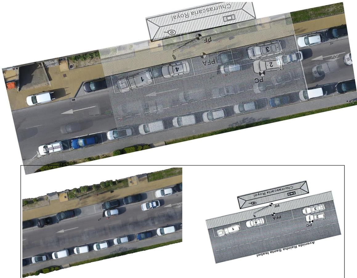
**Figura 5.38** – (Em cima) Sobreposição do ortomosaico gerado a partir das imagens adquiridas por *drone* com a planta realizada pela PSP, a partir do croqui desenhado no local do acidente. (Em baixo) Os dois modelos para mais fácil comparação.
