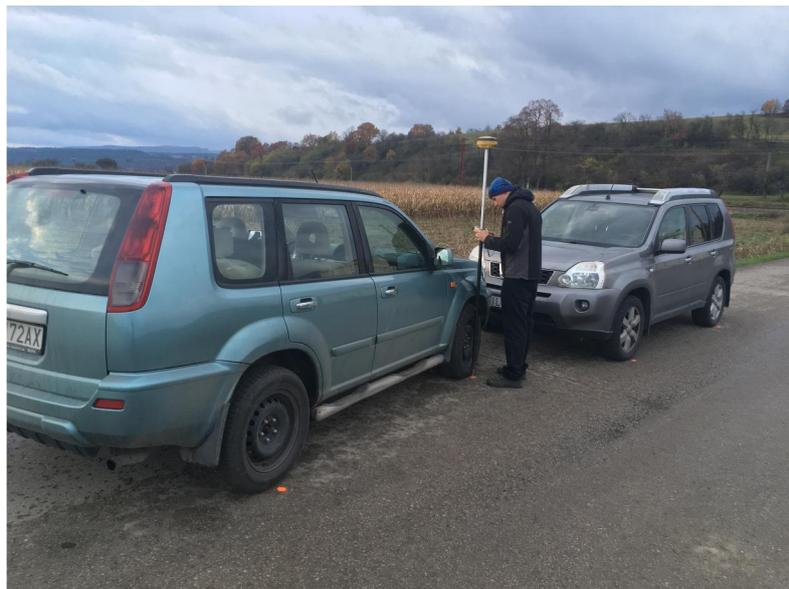
**Figura 5.8** – Medições de distâncias recorrendo ao recetor GNSS Topcon HiPer II.
