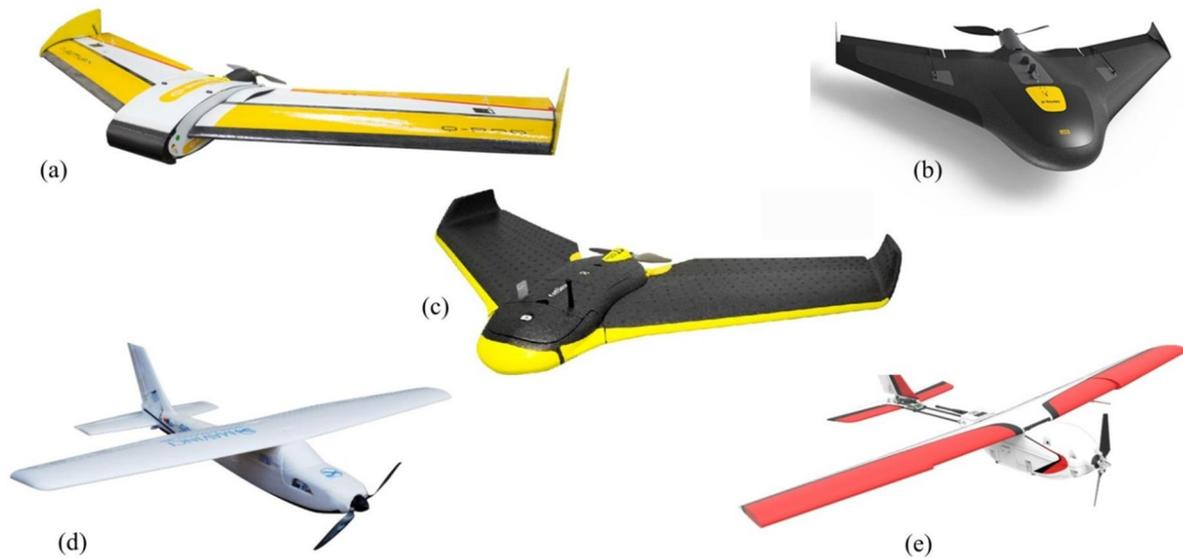
**Figura 3.3** – Alguns dos UAV de asa fixa comerciais mais populares: (a) QuestUAV Q-Pod; (b) Trimble UX5; (c) SenseFly eBee; (d) MAVinci Sirius Pro; e (e) PrecisionHawk Lancaster. A UTAD possui os modelos eBee e Lancaster. As imagens foram obtidas a partir dos sítios web dos fabricantes.
