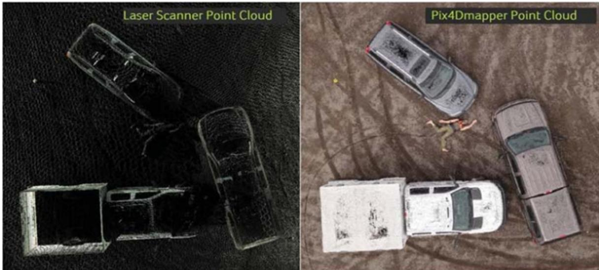
**Figura 4.4** – Comparação entre a nuvem de pontos obtida com o *Laser scanning* (Esquerda) e a nuvem de pontos resultante do processamento das imagens obtidas com o *drone* (direita) (Pix4D, 2014).
