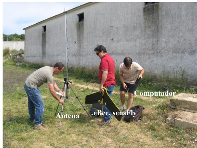
**Figura 3.8** – A estação de controlo terrestre (GCS) do eBee (senseFly).
