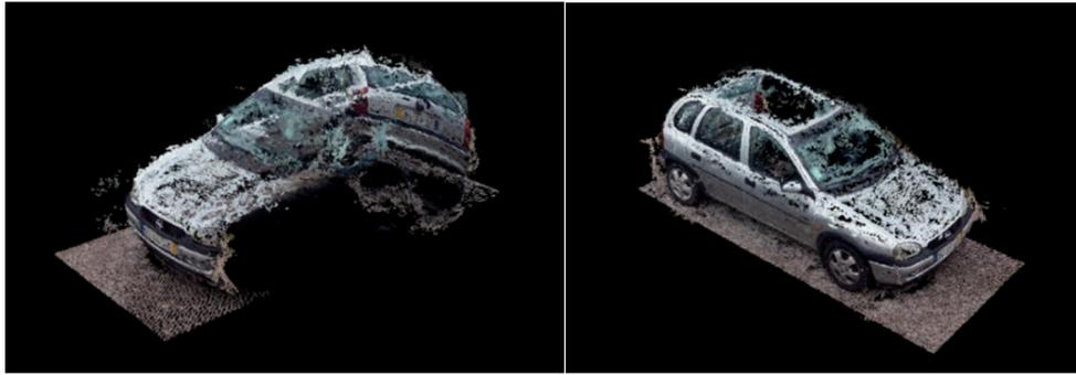
**Figura 5.11** – Nuvem densa de pontos gerada a partir das imagens obtidas por *smartphone*.
