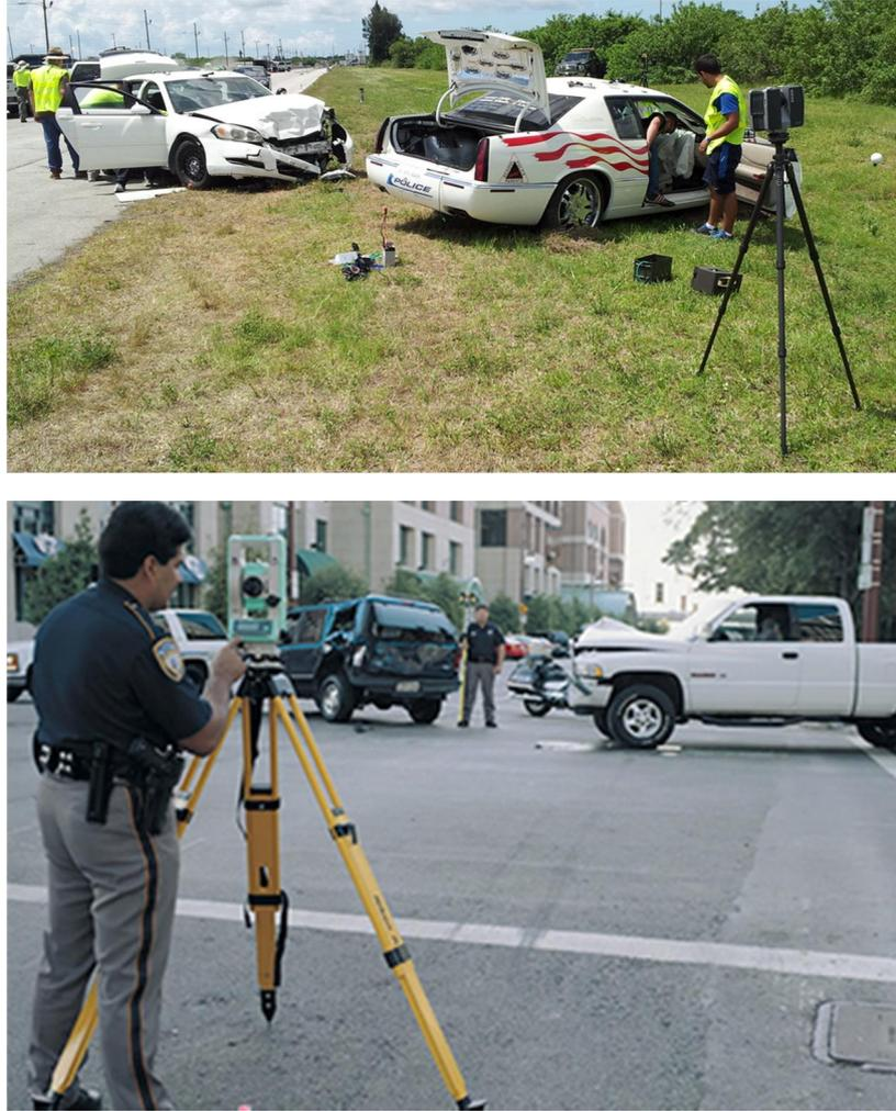
**Figura 2.5** – Utilização do laser *scanning* (em cima) e da estação total (em baixo) na investigação de acidentes rodoviários (imagens retiradas de <http://www.atlanticlaserscanning.com/accident-reconstruction.html> e <https://store.csdsinc.com/departments/accident-forensic-investigation-%7C01%7CARE.html>, respetivamente).
