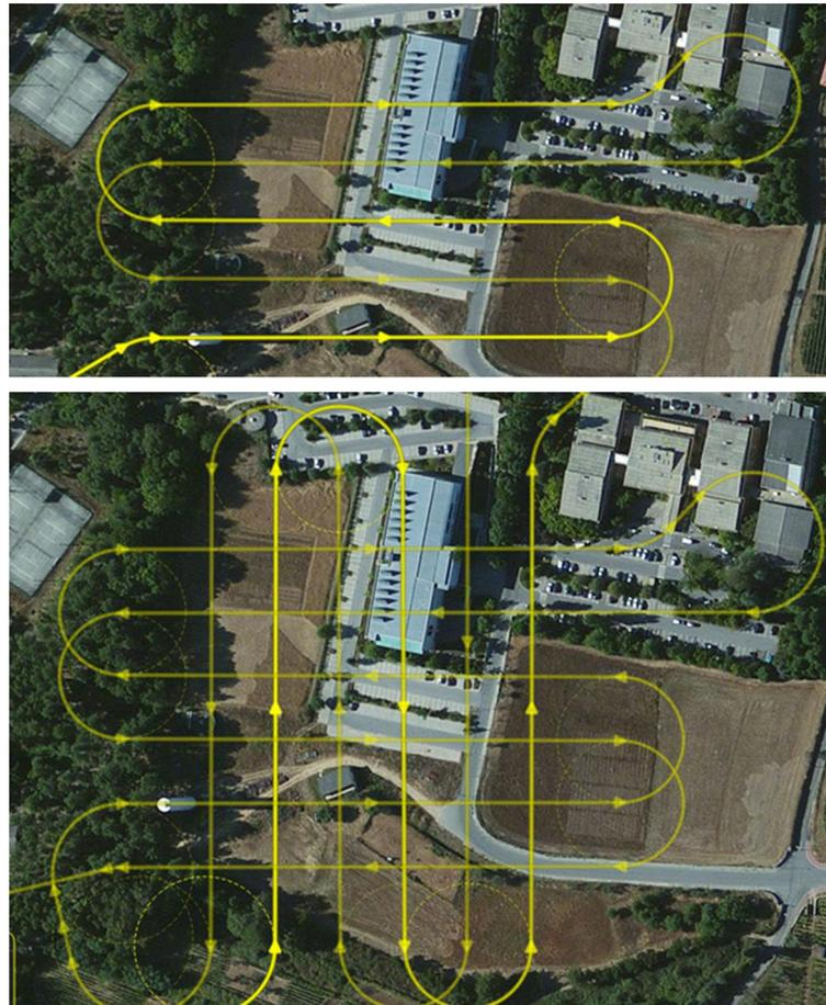
**Figura 5.4** - Exemplo de um plano de voo com grelha simples (em cima) e com grelha dupla (em baixo).
