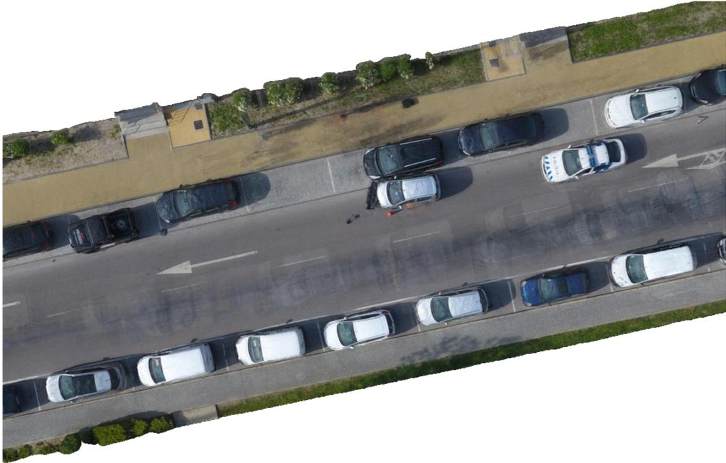
**Figura 5.36** – O mosaico gerado a partir das imagens adquiridas com o *drone*.
