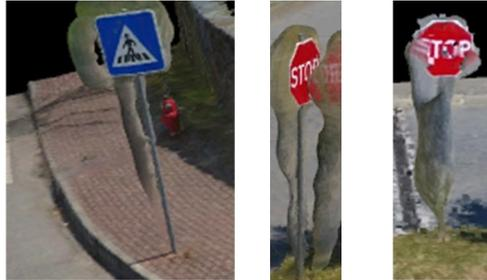
**Figura 5.42** – Exemplo de identificação da sinalização vertical no modelo 3D.
