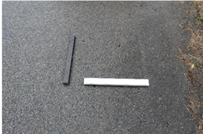
**Figura 5.5** – Barras metálicas utilizadas para constrangimento da escala.
