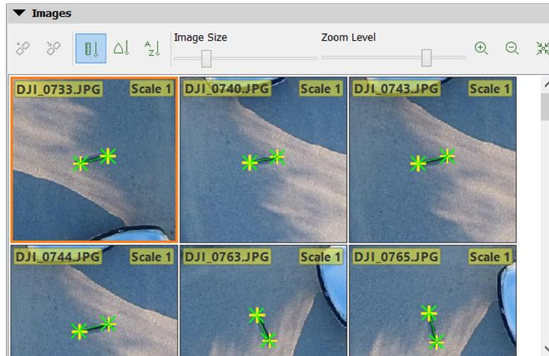
Figura 5.3 – O processo de constrangimento da escala no *Pix4Dmapper Pro*.
