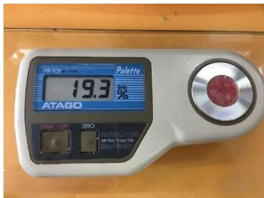
**Figura 17.** Refratómetro digital (PR-101, Atago, Japão).
