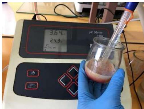
**Figura 18.** Medidor de pH Jenway.
