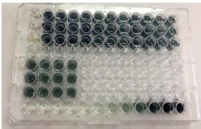
**Figura 20.** Aspeto da microplaca na determinação dos (poli)fenóis totais.
