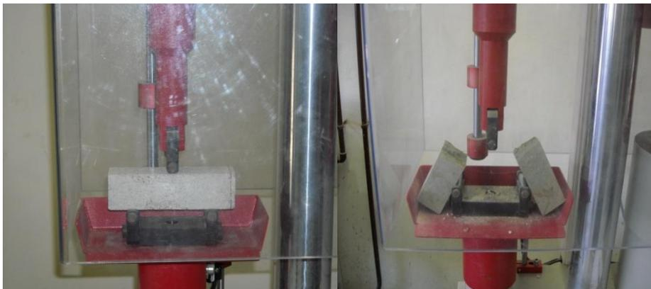
**Figura 6.16** – amostra de ensaio à rotura por flexão.
