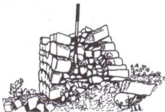
**Figura 2.14** – Corte transversal duma parede colapsada.
