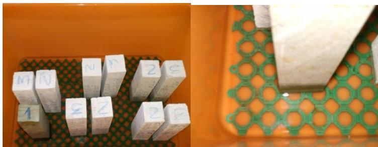
**Figura 6.14** – Esquema de montagem/ensaio, absorção de água por capilaridade.
