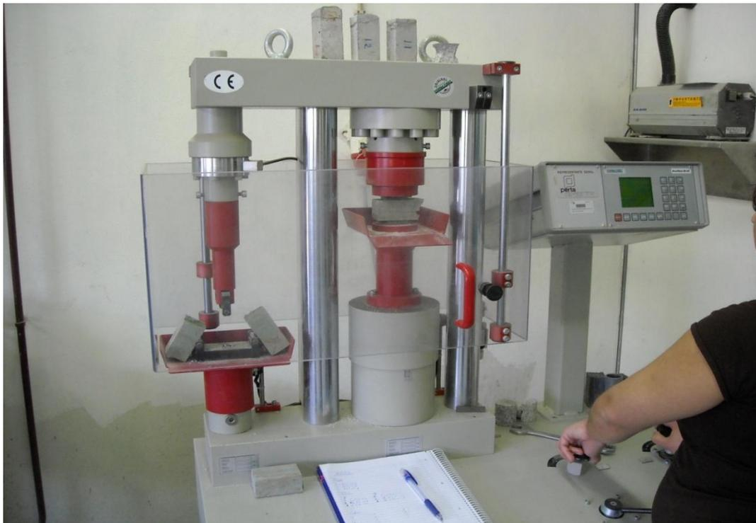
**Figura 6.5** – Máquina de ensaio de flexão e compressão.
