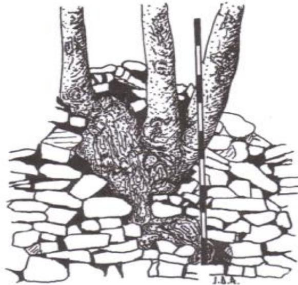
**Figura 2.24** – Degradação de alvenaria seca devido ao crescimento de vegetação de grande porte. (RODRIGUES, 1988)
