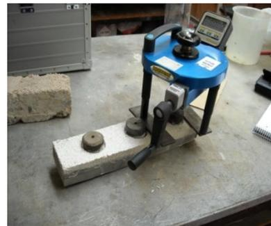
**Figura 6.12** - Representação esquemática do ensaio de pull-off e imagem do aparelho utilizado no ensaio pull-off – “*caracterização do comportamento da ligação entre betões de distinta classe de resistência*”.
