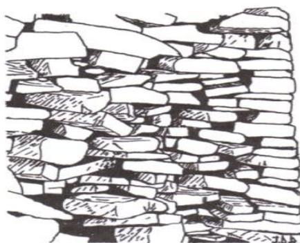
**Figura 2.13** – Corte transversal duma parede colapsada.
