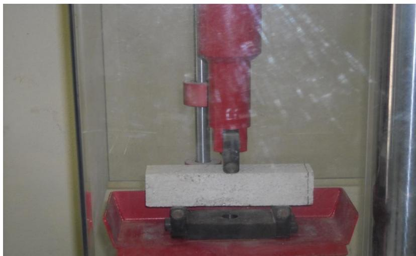
**Figura 6.6** – Máquina de ensaio de flexão e compressão.
