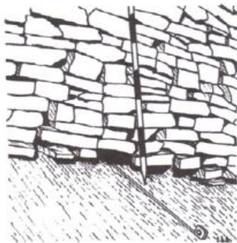
**Figura 2.27** – A remoção dos blocos inferiores pode favorecer a rotação para o exterior e causar abaulamento e colapso. (RODRIGUES, 1988)
