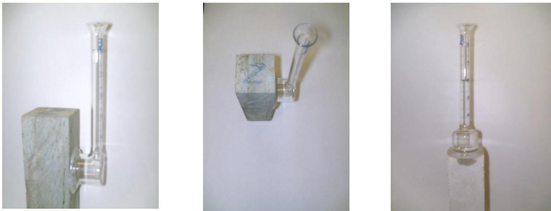
**Figura 6.15** – Esquema de montagem/ensaio, Método do Tubo (de Karsten).
