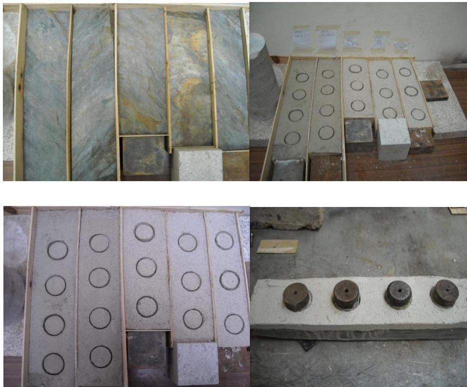
**Figura 6.10** – Cama de reboco, execução dos carotes, colagem das pastilhas após cura na câmara húmida até à data do ensaio.
