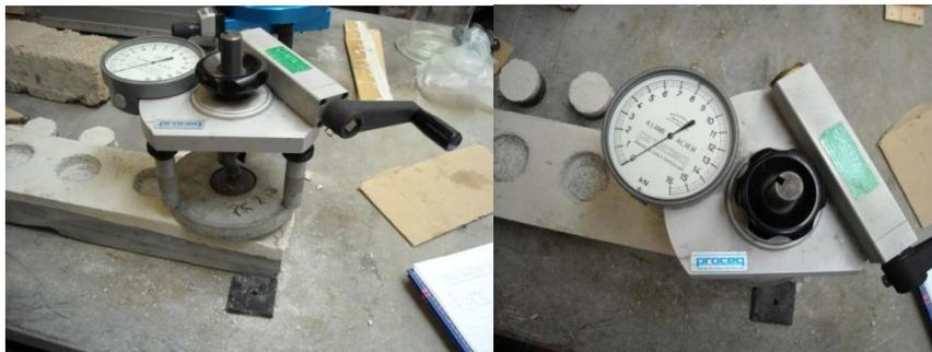
**Figura 6.17** – Ensaio de arrancamento.
