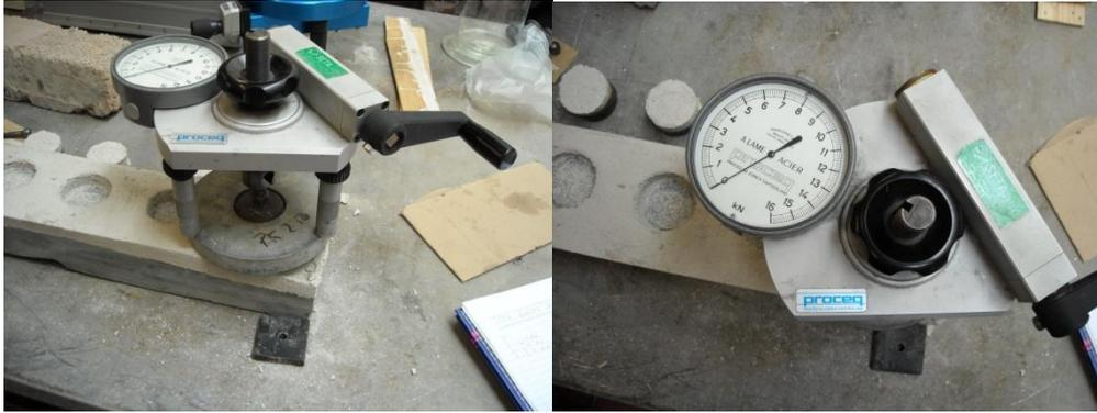
**Figura 6.11** - Aparelho de arrancamento “Proceq DYNA Z15”
