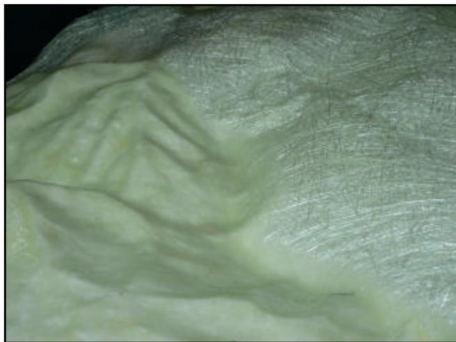
**Fotografia 25 - Pormenor da tela impregnada com a resina (lado esquerdo da fotografia) e antes da colocação da resina (lado direito).**
