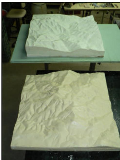
**Fotografia 19 - Aspecto do molde de gesso obtido nesta fase (parte superior da fotografia) e do contra molde (parte inferior da fotografia) resultante das fases anteriores.**
