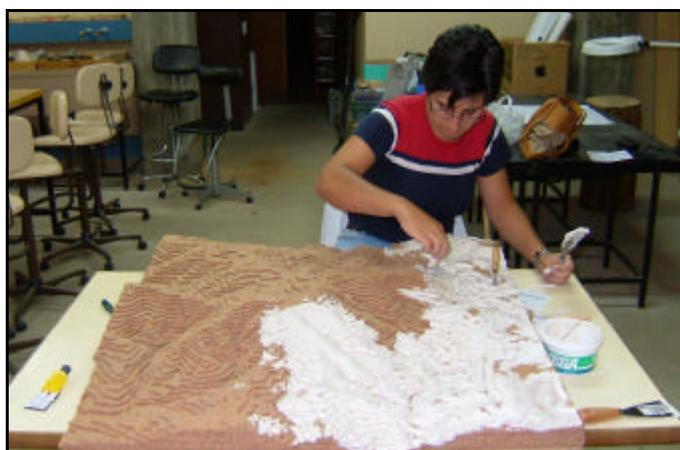
**Fotografia 13 - Preenchimento da maquete em corticite com a massa vega.**
