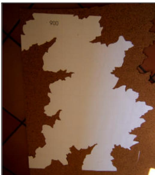
**Fotografia 9 - Transferência dos mapas de cotas individualizadas para as placas de corticite.**
