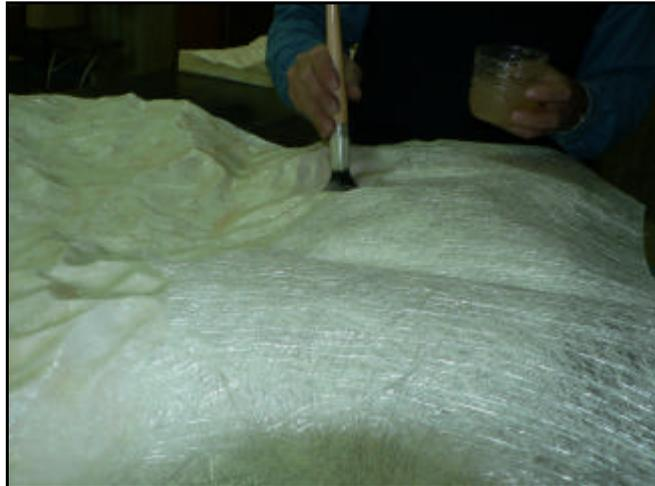
**Fotografia 24 - Colocação da resina sobre a tela de fibra de vidro.**
