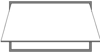
Fig. 27 – Janela de eixo superior de abrir para dentro (GOMES,A.M. ; 2009)
