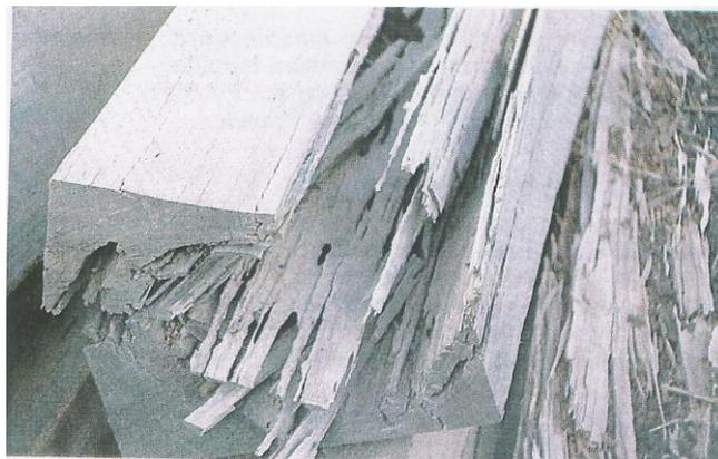
Fig. 52 - Trave de eucalipto destruída pelas térmitas (ROBBIALAC; 2009)
