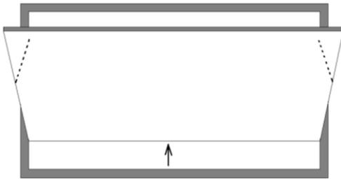
Fig. 44 – Janela de ventilação simples
