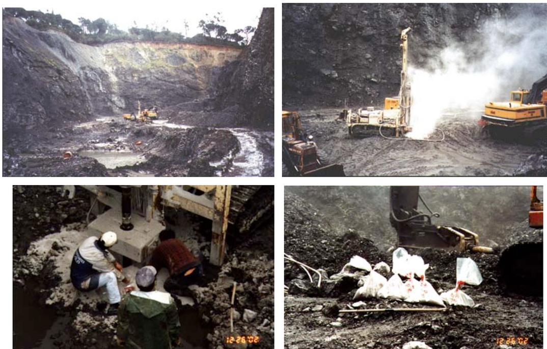
Figura 2 – Sondagem e amostragem do gesso da pedreira “Picotas nº 1”.
