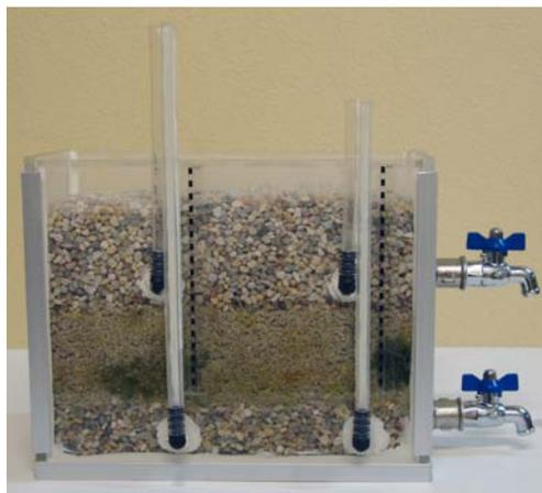
Figura 3 - Modelo para simulação do comportamento hidráulico de aquíferos livre e semi-cativo.
