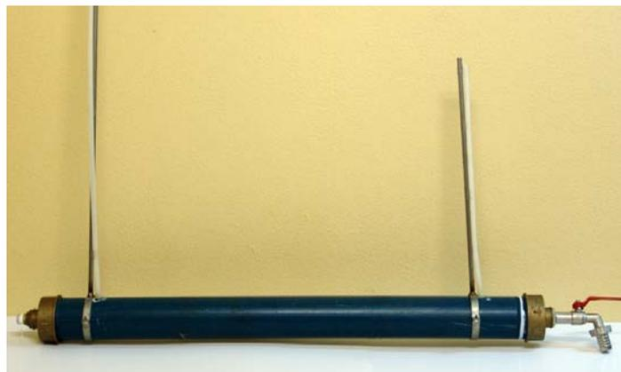
Figura 1 - Modelo para experimentação da lei de Darcy.
