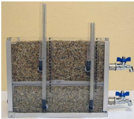
Figura 2 - Modelo para simulação do comportamento hidráulico de aquíferos livre e cativo.
