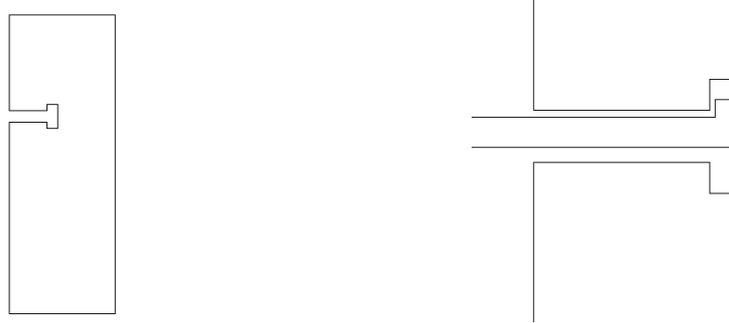
Figura 5.9.2 – Fixação do tipo oculta, exemplo de tipo “rolha de champanhe”
