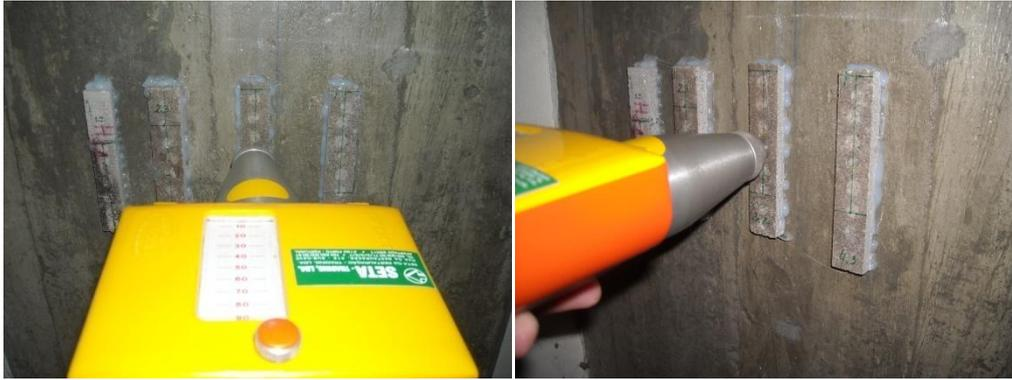
Fotografia 5.8.1 - Fotografias do ensaio de esclerómetro
