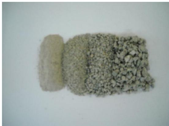
Fotografia 4.2 - Inertes usados
