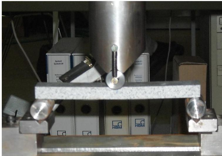
Fotografia 5.6.1 - Fotografia de um ensaio de flexão
