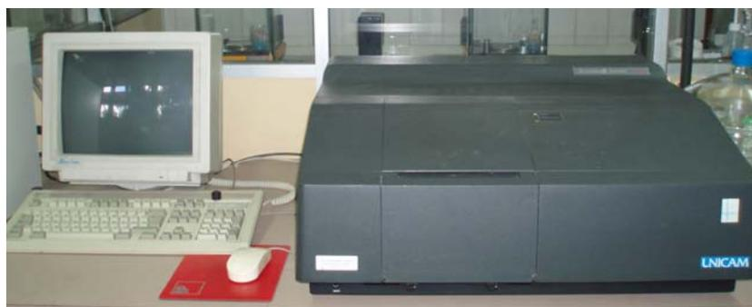
Figura 5.5 Fotografia do equipamento de espectroscopia de infravermelho com transformada de Fourier (FTIR) utilizado.
