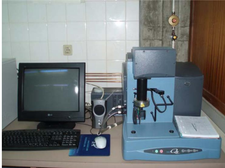
Figura 5.2 Fotografia do equipamento de análise termogravimétrica (ATG) utilizado.
