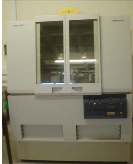
Figura 5.8 Fotografia do equipamento de difracção de raio X utilizado.
