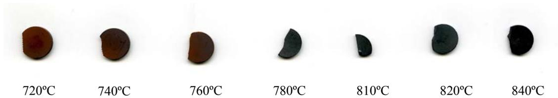
Figura 7.8 Fotografias das amostras com tratamento térmico a diferentes temperaturas, durante 1 hora.
