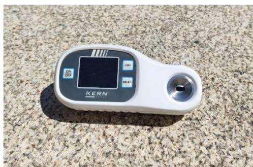
Figura 4 - Refratómetro Digital Utilizado no Estudo
