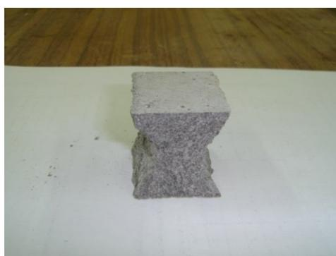
**Figura 23:** Provetes após ensaio à compressão
