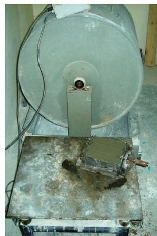
**Figura 18:** Vibração dos moldes
