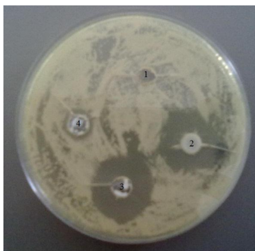
Figura 19 - Zonas de inibição dos hidrogéis preparados e da formulação comercial oral: 1 – HG; 2 – Daktarin ® ; 3 – HG-NLC 2b M e 4 – HG-NLC 2b P.
