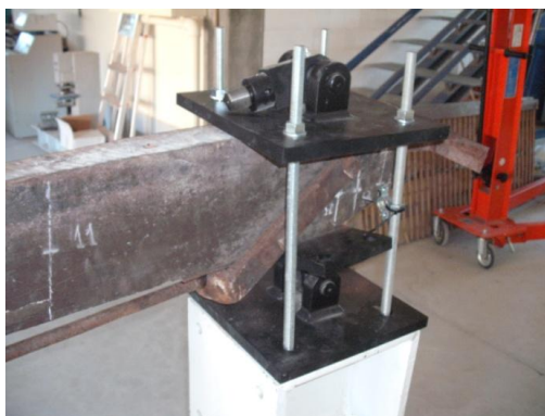
Figura 4.13 – Apoios da viga (Julho de 2012)
