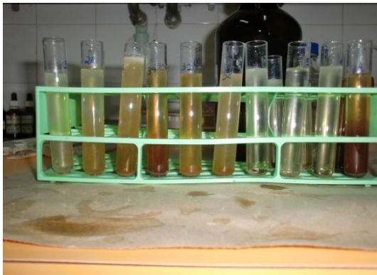
Figura 11 - Tubos com amostras diluídas em hidróxido de potássio, após centrifugação (Foto original).
