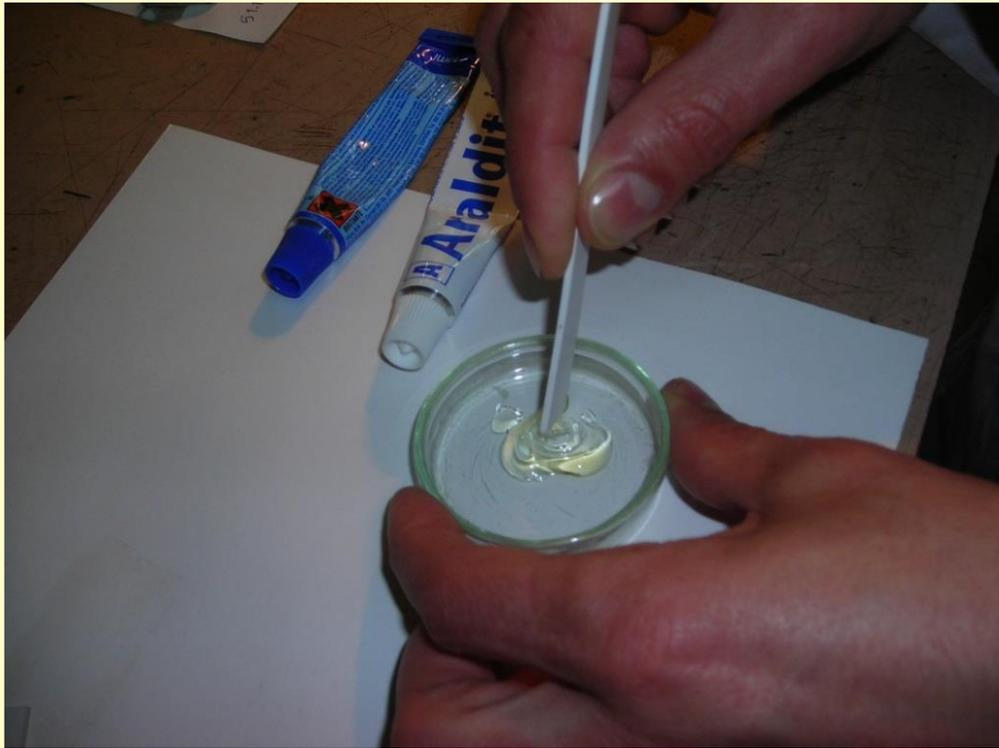
Fotografia 48 - Homogeneização da cola (Araldite) com a resina (Laboratório de Geologia, UTAD, 2014)
