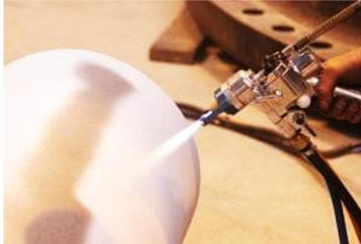
*Fotografia 20 - Metalização por projeção térmica em chama (Manutenção & Suprimentos, 2016)*
