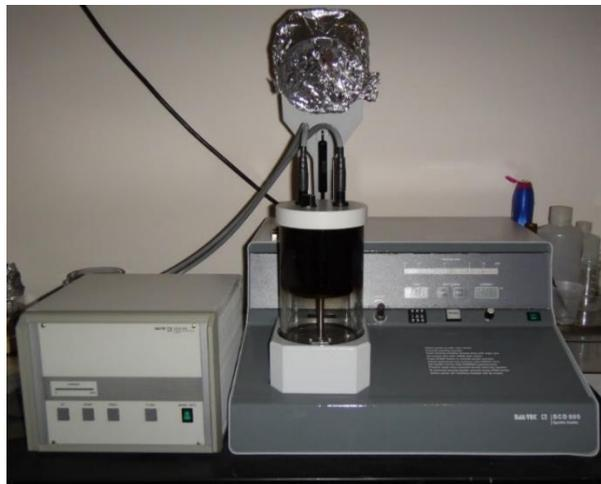
*Fotografia 50 - Equipamento usado para metalização das amostras (LNEG, 2015)*
