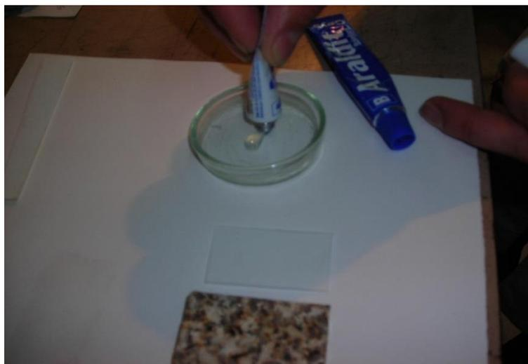
*Fotografia 47 - Colocação da resina num recipiente (Laboratório de Geologia, UTAD, 2014)*
