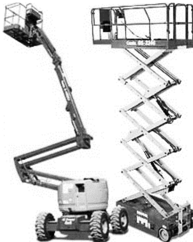
*Figura 33 - Plataforma de trabalho elevatória (Projectar Projecto, 2015)*
