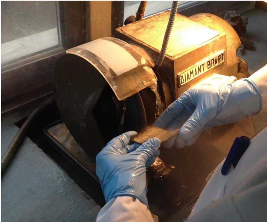
*Fotografia 43 - Corte da amostra da placa de fibrocimento (Laboratório de Geologia, UTAD, 2014)*
