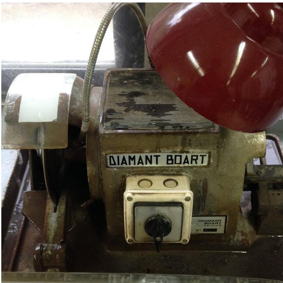
Fotografia 42 - Máquina de corte utilizada no corte da amostra (Laboratório de Geologia, UTAD, 2014)
