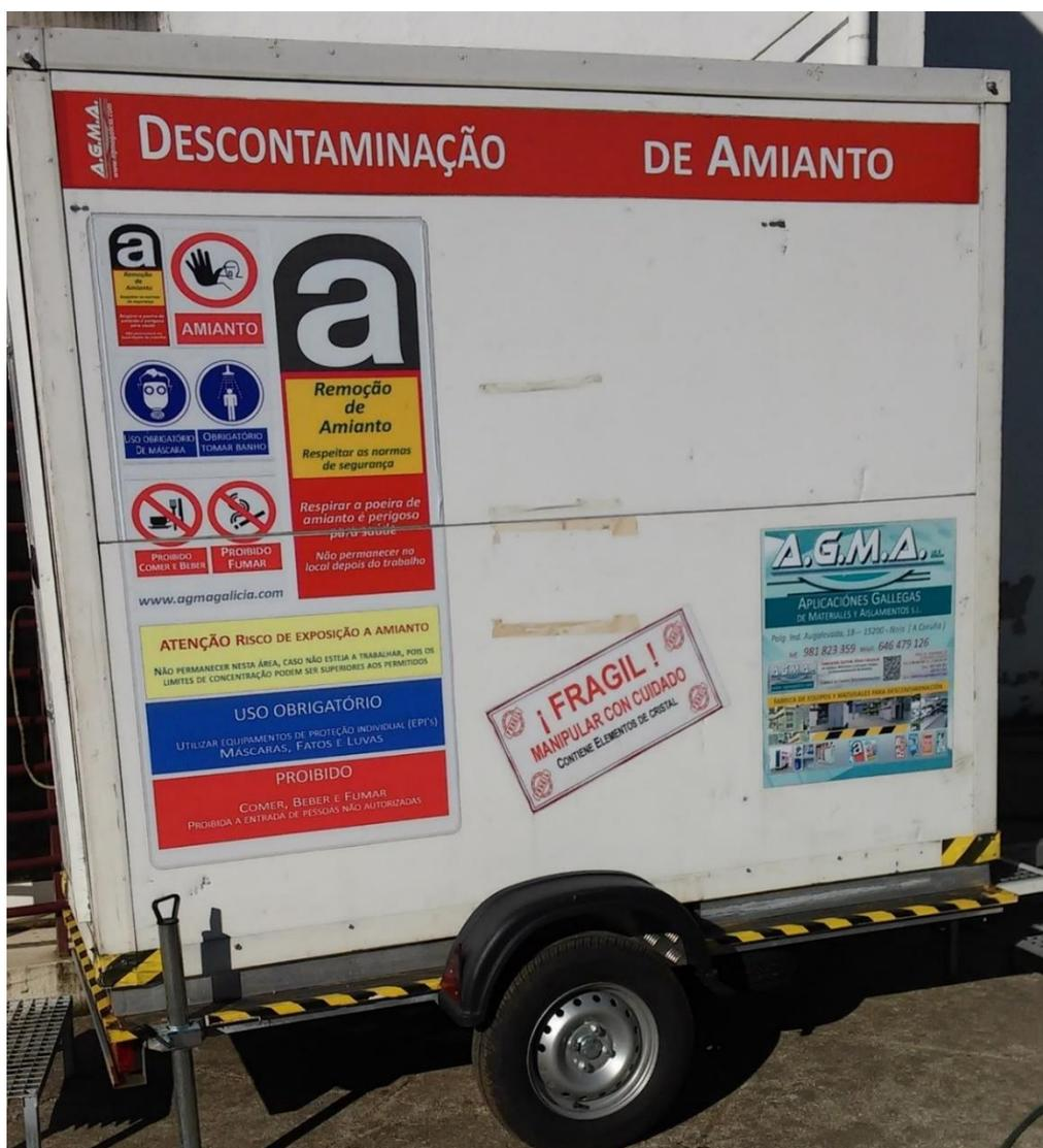
Fotografia 30 - Unidade de descontaminação (PGCSPM, 2015)
