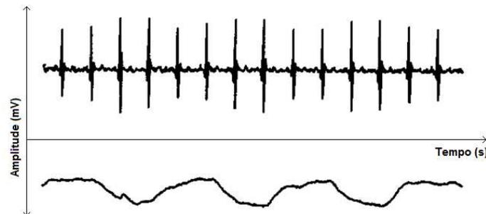
**Figura 2.5** – Modulação da amplitude do complexo QRS induzida pela respiração. Traçado superior: ECG; Traçado inferior: respiração medida por um transdutor piezoelétrico colocado no peito. Duração: 10 segundos. Adaptado de [Moody et al. \(1985\)](#)
