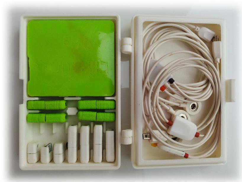
**Figura 6.3** – Encapsulamentos impressos em PLA e Filaflex para armazenamento do *BITalino (r)evolution Plugged Kit BT*, e respetivos componentes.
