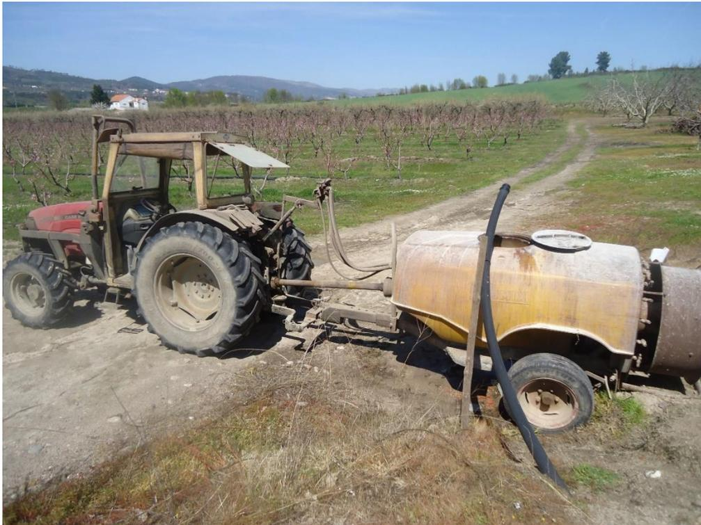
Figura 15 - Trator com pulverizador de turbina rebocado
