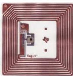
**Figura 2.8** – Exemplo de uma etiqueta RFID obtida em <http://www.sagedata.com>.
