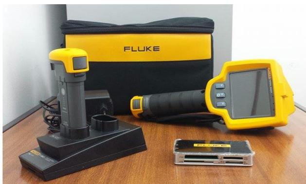
Figura 4 – Câmara Termográfica.
