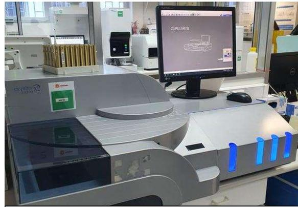
Figura 16-Equipamento Capillarys II da Sebia. Foto gentilmente cedida por Unilabs.
