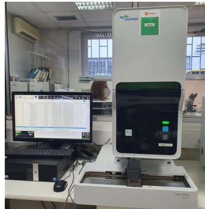
Figura 4-Aparelho Sysmex XN-1000.
