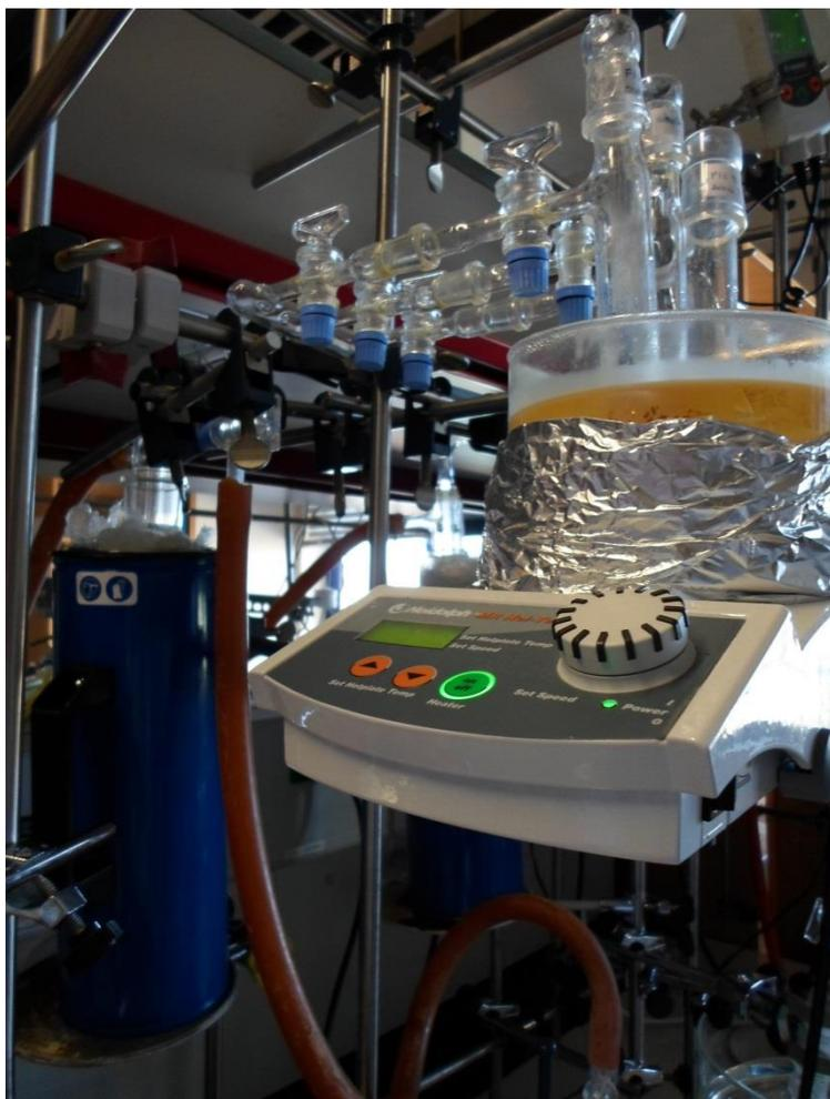
*Figura 1.* Sistema de vácuo para secagem dos líquidos iônicos.
