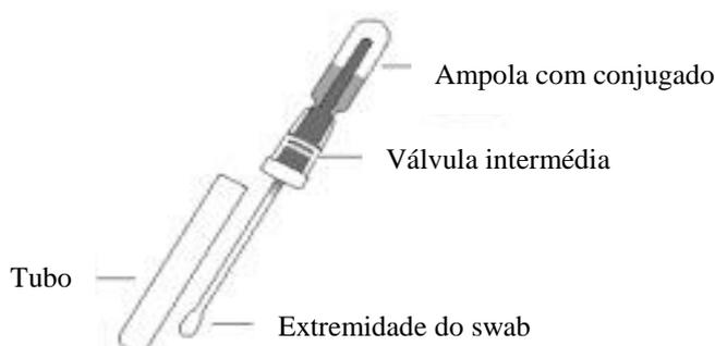
**Figura 3-** Componentes do teste Snap® Parvo.
