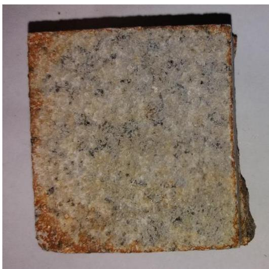
Figura 53 – Amostra de granito de Pedras Salgadas após 5 dias submersa (dimensão 7,5×7,5cm).
