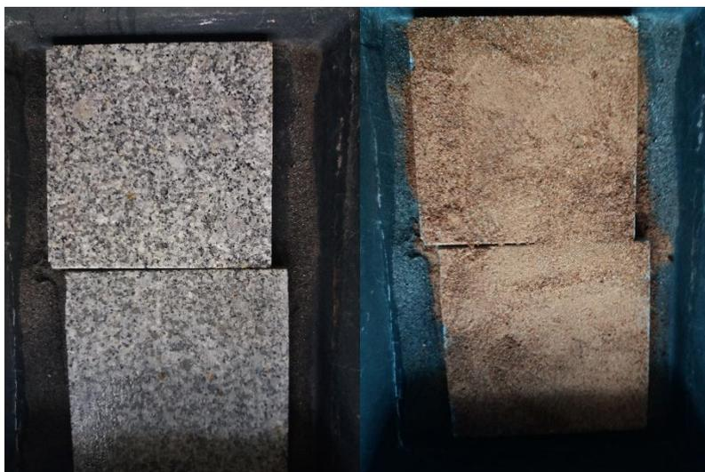
Figura 52 – Granito de Pedras Salgadas sem óxido de ferro (esquerda) e com uma camada de óxido de ferro e areia (direita).
