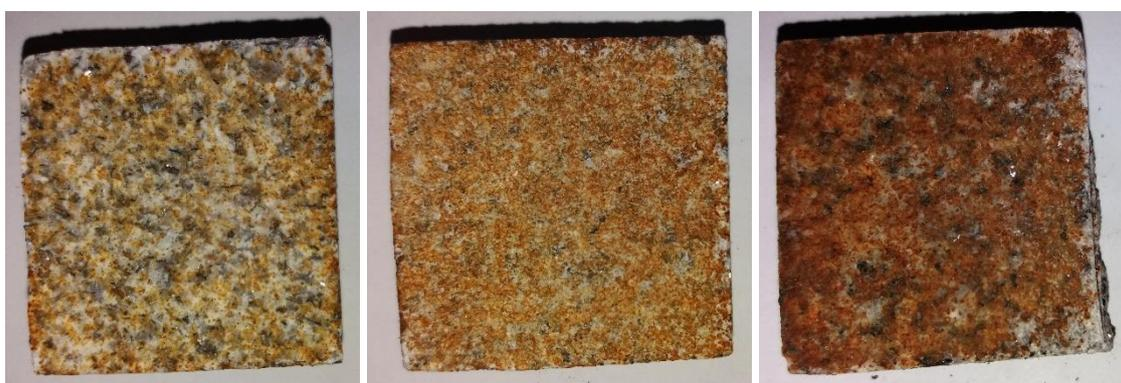
Figura 54 – Amostras coloridas com óxido de ferro, 1 dias (esquerda), 2 dias (centro) e 5 dias (direita).
