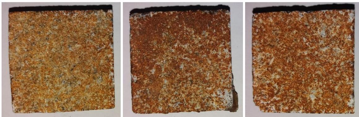
Figura 56 – Amostras de granito de Pedras Salgadas (esquerda), Cinza Telões (centro) e Branco Micaela (Direita), com tempo de coloração de dois dias.
