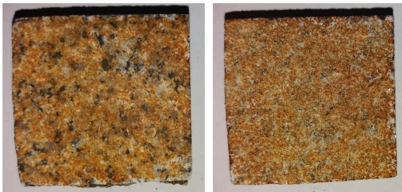
Figura 55 – Amostras de granito de Pedras Salgadas, amaciado à esquerda e serrado à direita após 2 dias.
