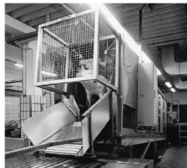
Figura 12. Equipamento de insensibilização eléctrica automático. (Fonte: Marchant-Forde, 2009).
