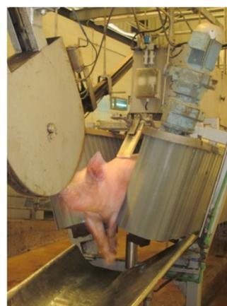
Figura 42. Sistema eléctrico de insensibilização de 2 eléctrodos. Fotografia de Alexandre Rodrigues.
