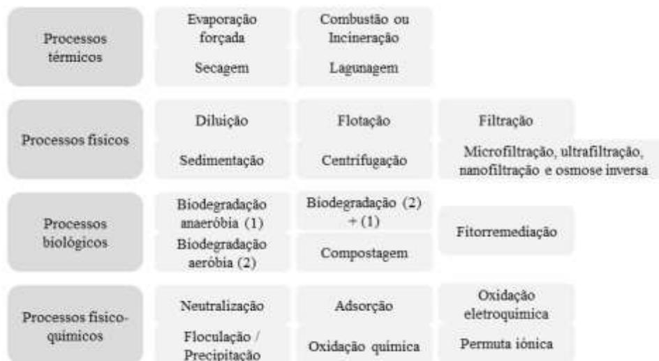
**Figura 2.2.** Processos de tratamento de efluentes de lagoas de azeite (Fonte: Jerónimo, 2012).
