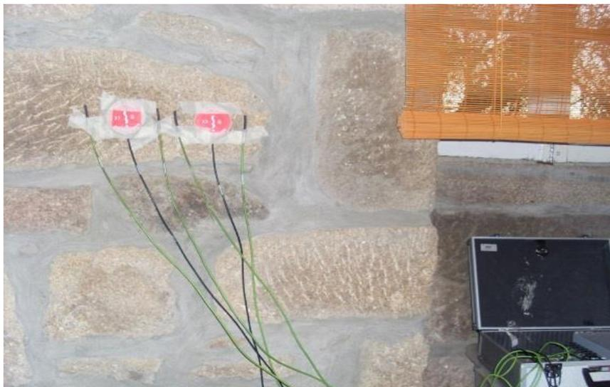
Figura 4.17 – Fixação dos aparelhos de medição de fluxo de calor no edifício de pedra de granito do caso de estudo 2
