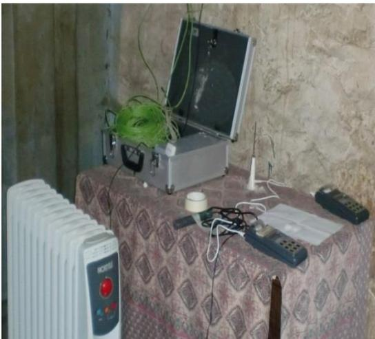
Figura 4.7 – Aparelhos de medição de fluxo de calor utilizados no ensaio
