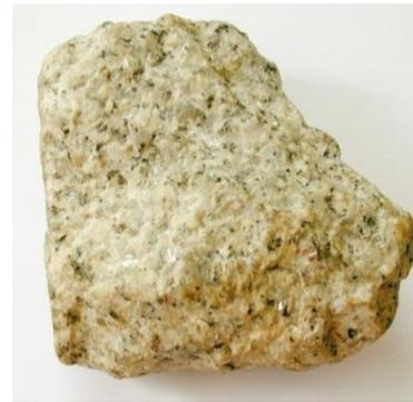
Figura 2.11 – Pedra de granito de duas micas [23]
