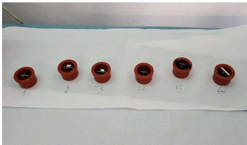
Figura 24 – Amostras posicionados no centro dos moldes
