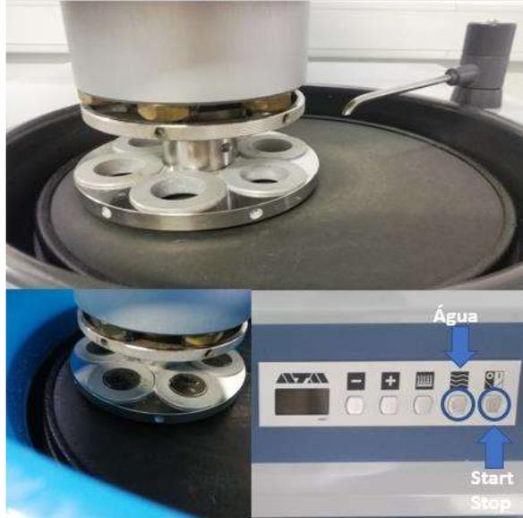
Figura 29 – Iniciação do desbaste abrasivo
