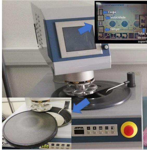
Figura 28 – Preparação da máquina de desbaste abrasivo
