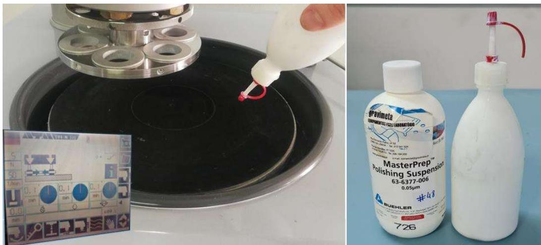
Figura 31 – Pré-seleção dos dados para o polimento (esquerda) e produto MasterPrep Polishing Suspension (direita)
