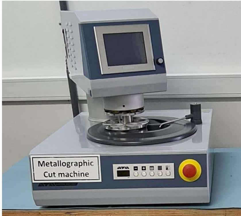
Figura 19 – Máquina de polimento Saphir 550 da ATM
