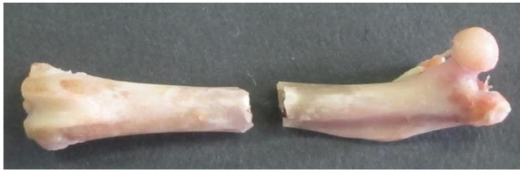
**Figura 4.10** – Modo de rotura dos provetes.
