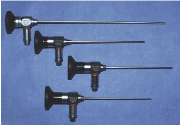
**Figura 14** Artroscópios usados na artroscopia de pequenos animais. Telescópio longo de 2,7 mm; artroscópios curtos: de 2,7 mm, de 2,4 mm e de 1,9 mm. Todos estes telescópios têm um ângulo de 30 graus. O telescópio de 2,7 mm tem uma lente de trabalho de 18 cm e os artroscópios têm uma lente de trabalho de 10 cm. (adaptado de McCarthy, TC, 2005)
