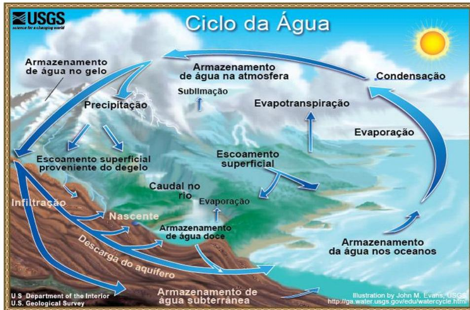
Figura 2.1 – Ciclo hidrológico; adaptado de Evans, USGS, 2009
