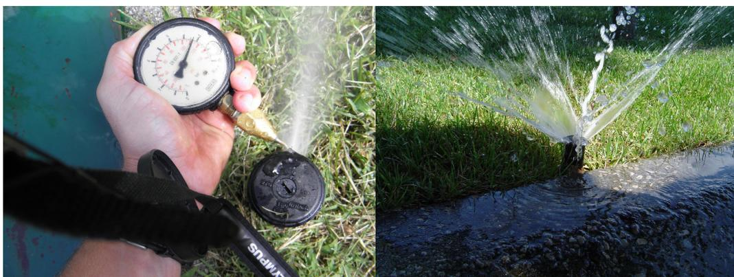
Figura 16 – Foto da Medição da Pressão e Pulverizador sem pressão – Parque Municipal do Antuã – Maio 2011 (Fonte SEV/CME)
