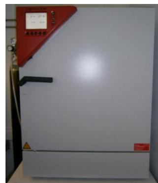
Figura 2.3. Incubadora de CO<sub>2</sub> (Binder CB150)
