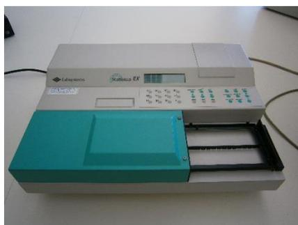
Figura 2.7. Espectrofotómetro de microplacas
