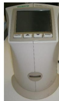
**Figura 2.4.** Contador de células automático
