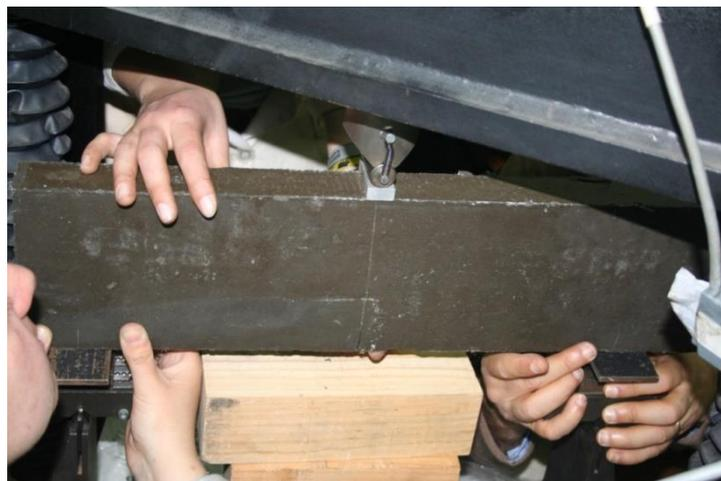
Figura 2.25- Processo de colocação do provete e ajustamento dos apoios.
