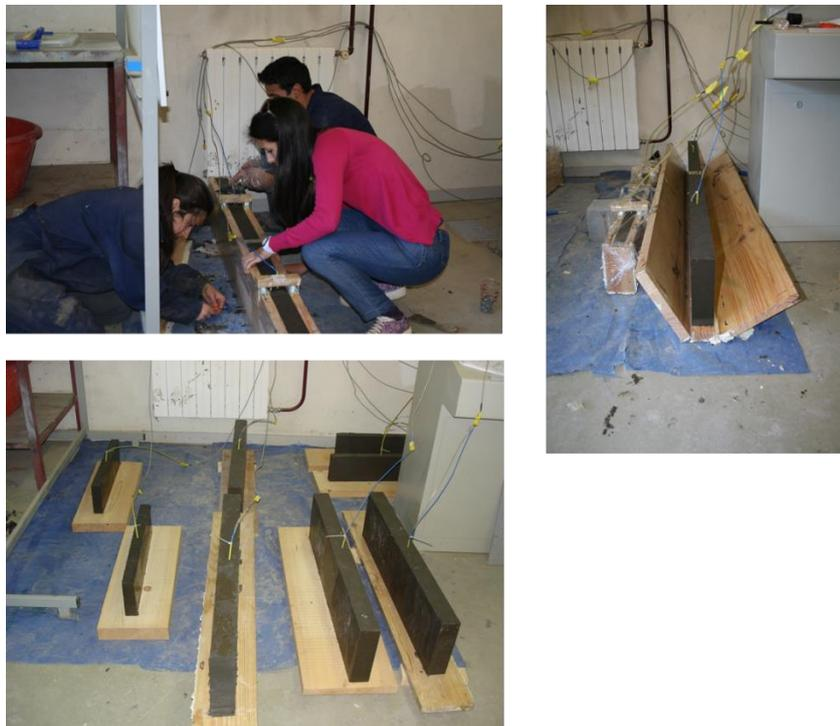
Figura 2.18- Provetes desmoldados.
