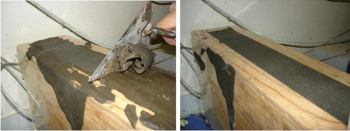
Figura 2.17- Alisamento da superfície dos provetes.
