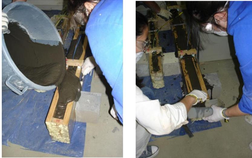
Figura 2.15- Colocação da mistura no interior dos moldes; remoção do seu excedentário.
