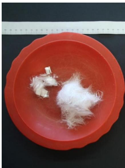
Figura 2.3- Fibras agrupadas (à esquerda) e fibras separadas (à direita).
