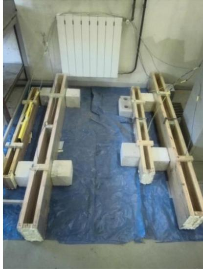
Figura 2.6- Moldes devidamente instrumentados antes da colocação da mistura.
