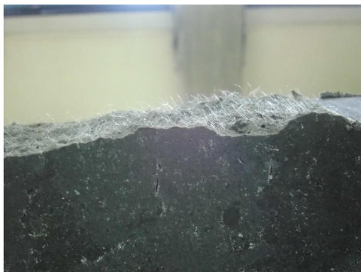
Figura 3.15 - Distribuição das fibras, na secção de fratura do provete.
