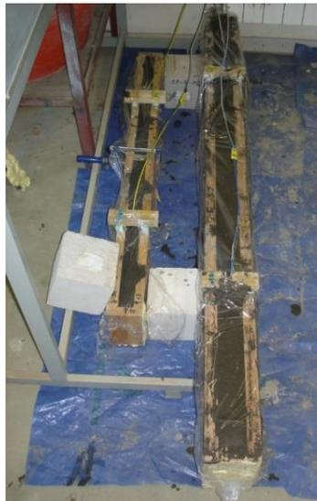
Figura 2.16- Moldes cobertos com plástico, para a água não evaporar.
