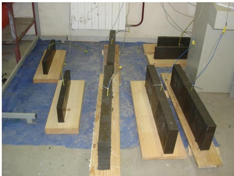
Figura 3.6- Posicionamento dos provetes, durante a secagem.
