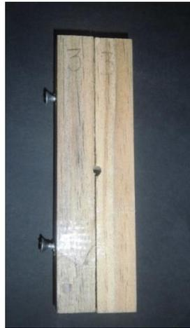
Figura 2.9- Peça de auxílio no posicionamento e fixação dos termopares.
