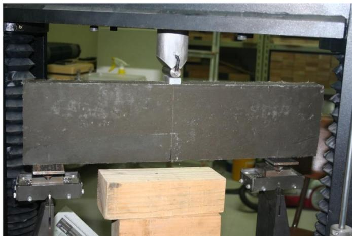
Figura 2.26- Configuração do ensaio SEN-TPB; início do ensaio.
