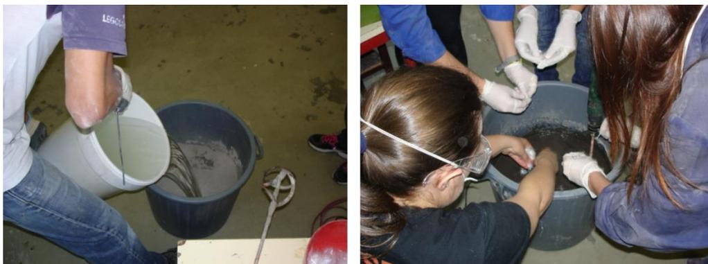
Figura 2.14- Adição do ativador (à esquerda) e das fibras (à direita).
