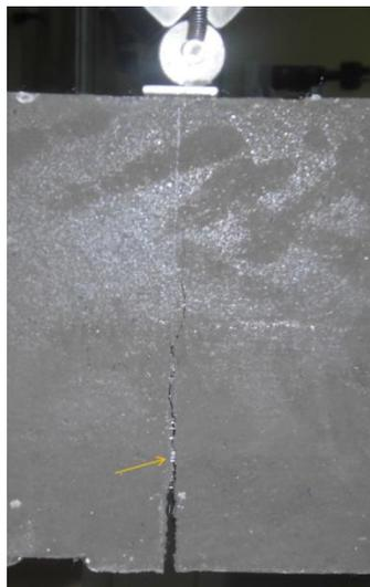
Figura 3.13 - Propagação da fenda durante o ensaio de fratura, salientando-se a presença das fibras.
